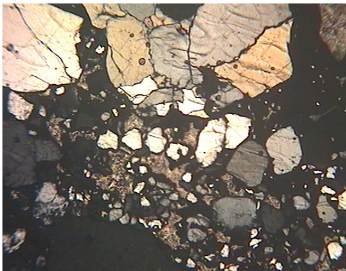
Figura 44. Mesma microfotografia anterior à luz polarizada (LP). Observa-se que os poros preenchidos por carbonato assumem cor de interferência clara. Comprimento da foto = 4 mm.
