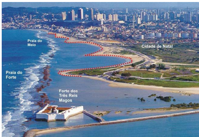
Foto 6. Efeitos das ondas incidentes sobre os recifes influenciando o formato das praias e o transporte de sedimentos – Natal / RN.
