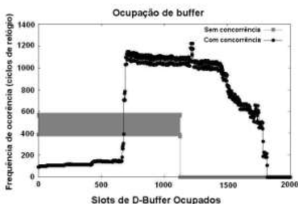
Figura 6.3 – Ocupação de D-buffer sendo o fluxo HDTV composto por pacotes de tamanho fixo de 1500 flits , sem (cinza) e com (preto) concorrência de pacotes HTTP de 1500 flits .
