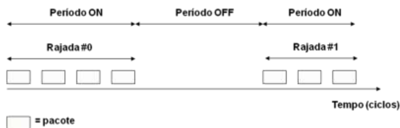
Figura 2.4 – Estrutura de um processo ON-OFF.
