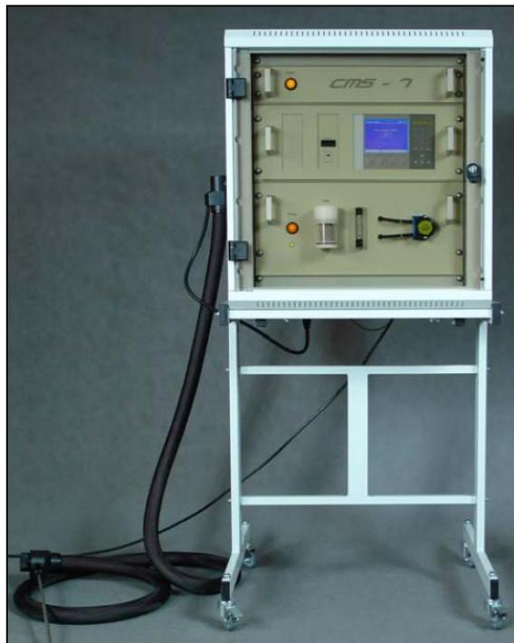
Figura 19 - Analisador dos gases CMS-7
