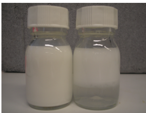
Figura 4.3. Aspecto das dispersões dos nanogéis obtidos utilizando 3 % em massa (à esquerda) e 2 % em massa (à direita) de Span 80 em relação à fase contínua.
