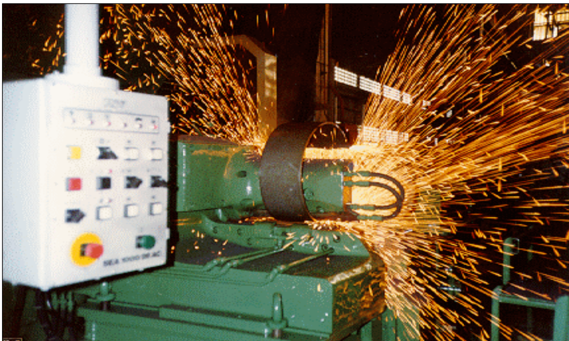
Figura 3. Uma das máquinas de soldagem por centelhamento existente na IOCHPE-MAXION.
