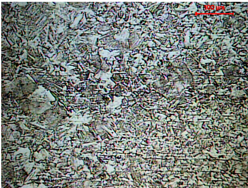
Figura 31. Fotomicrografia da região de transição SOLDA/ZTA do aço S275JR. Ampliação de 200x. Ataque químico: Nital 3%.
