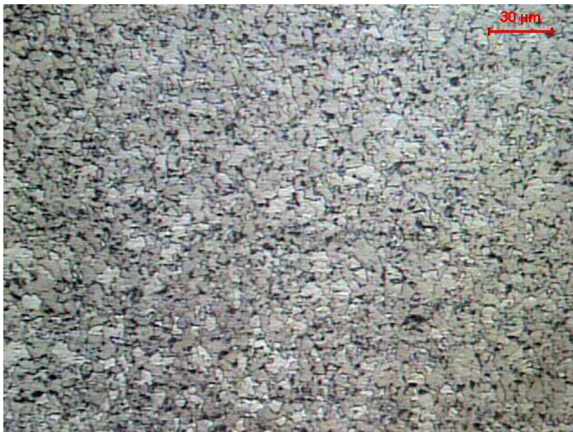
Figura 38. Fotomicrografia da região da ZTA-Metal Base do aço RD480. Ampliação de 500x. Ataque químico: Nital 3%.
