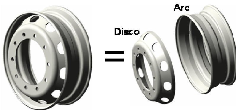
Figura 1. Componentes de uma roda sem câmara para caminhões e ônibus
