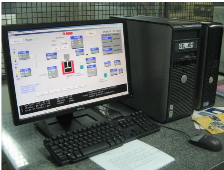
Figura 3.4 – Sistema de controle e aquisição de dados da planta FT.
