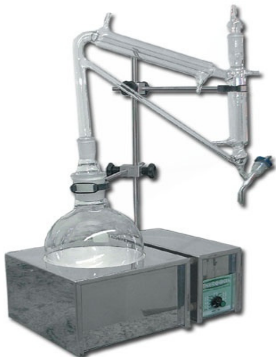
Figura 5 - Aparado de Hidrodestilação Clevenger usado para a extração do óleo essencial.
