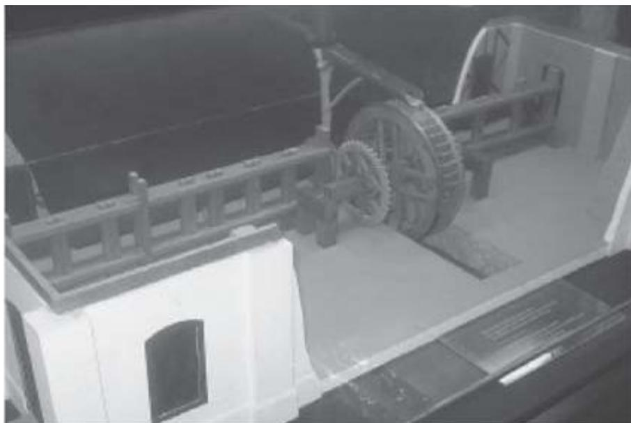
**Figura 2** Maquete existente no Museu da Pólvora do Jardim Botânico do Rio de Janeiro, que mostra uma reconstituição do sistema de pilões acionados mecanicamente e usados no fabrico da pólvora na fábrica estabelecida pelo Príncipe Regente D. João em 1808. A instalação se parece muito com aquela da Figura 1.<sup>54</sup>
