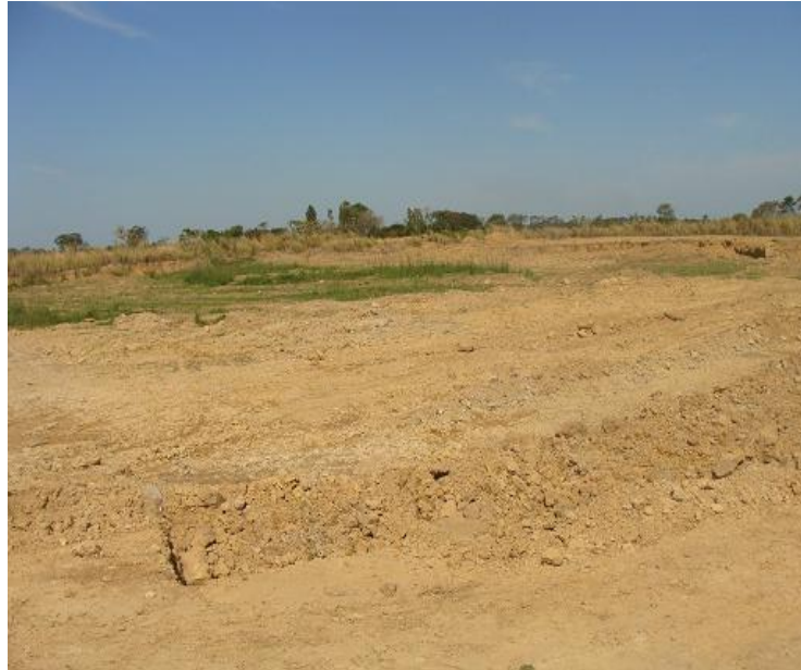
Figura 11 – Jazida sem reposição do horizonte A após a extração de argila. Foto: do autor.
