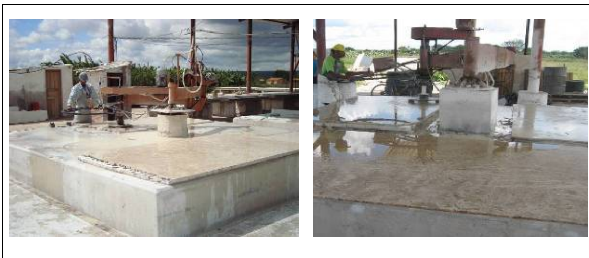
Figura 7: Polimento feito com a Politriz manual. Foto: Calhau, 2008.
