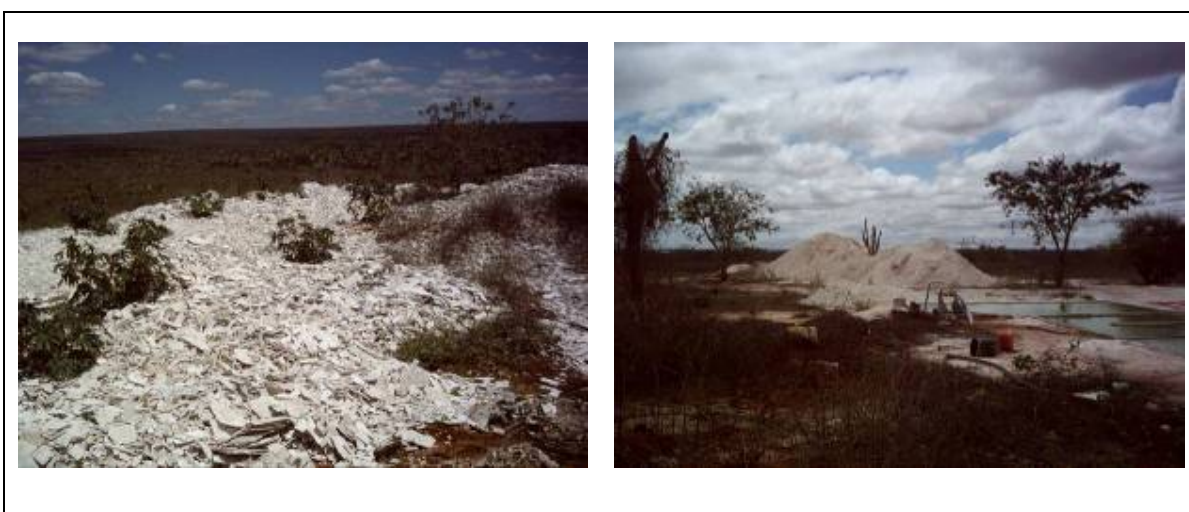
Figura 10: Resíduos sólidos gerados no processo de beneficiamento do mármore Bege. Foto: Calhau, 2008.
