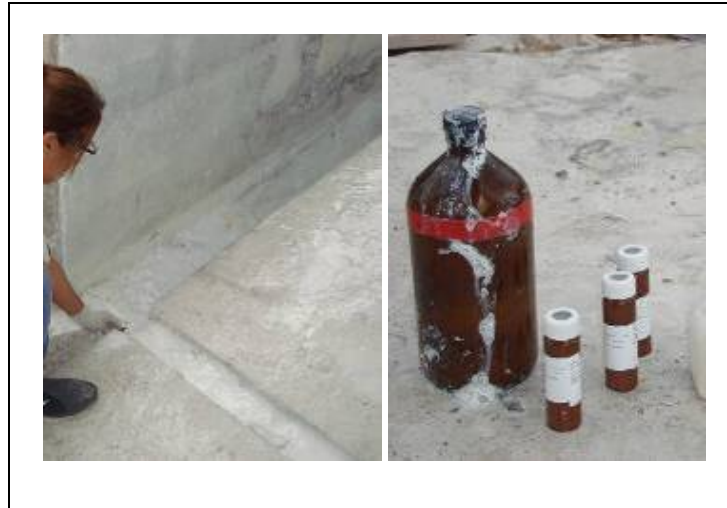
Figura 15: Amostragem de efluentes líquidos gerados no processo de beneficiamento do mármore Bege. Foto: Calhau, 2008.
