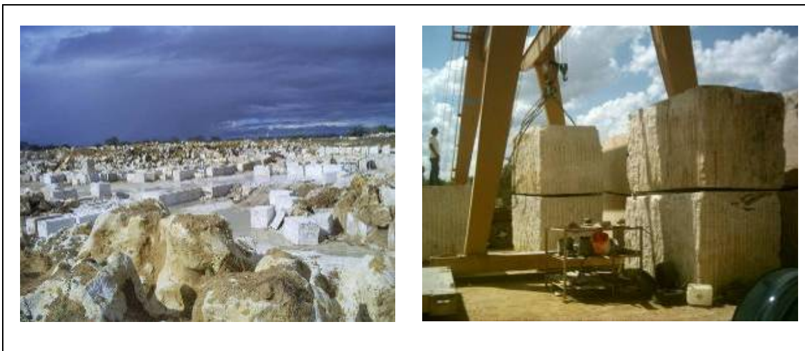
Figura 1: Esquerda: extração de blocos na pedreira. Direita: preparação de blocos para o beneficiamento. Foto: Calhau, 2008.
