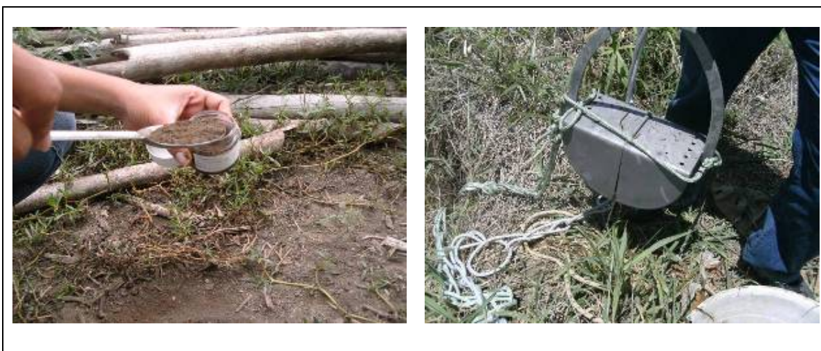
Figura 19: Esquerda: amostragem de solo. Direita: Draga de Van Veen. Foto: Calhau, 2008.
