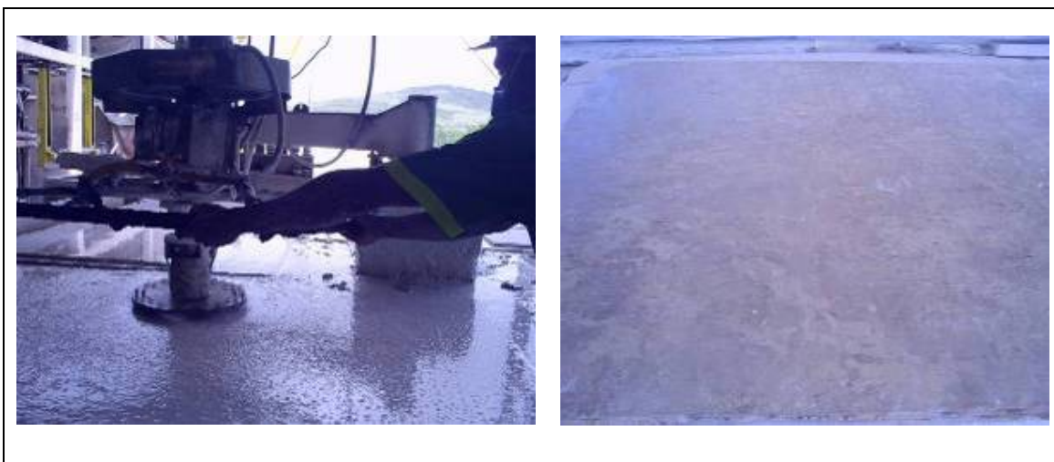
Figura 5: Etapa de levigamento evidenciando chapa lisa e plana. Foto: Calhau, 2008.
