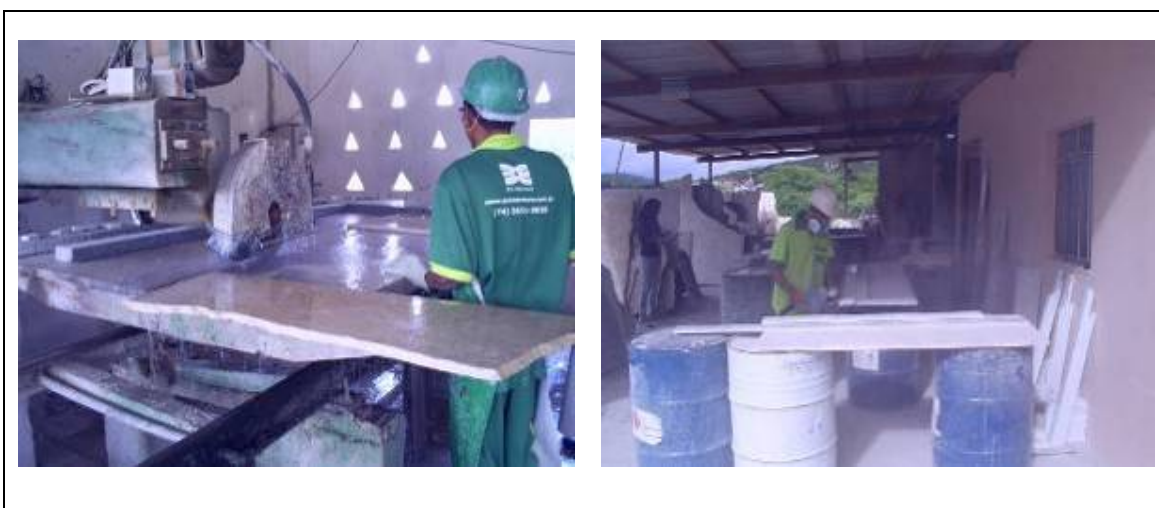
Figura 8: Cortadeira de bancada (esquerda) e lixadeira manual (direita). Foto: Calhau, 2008.
