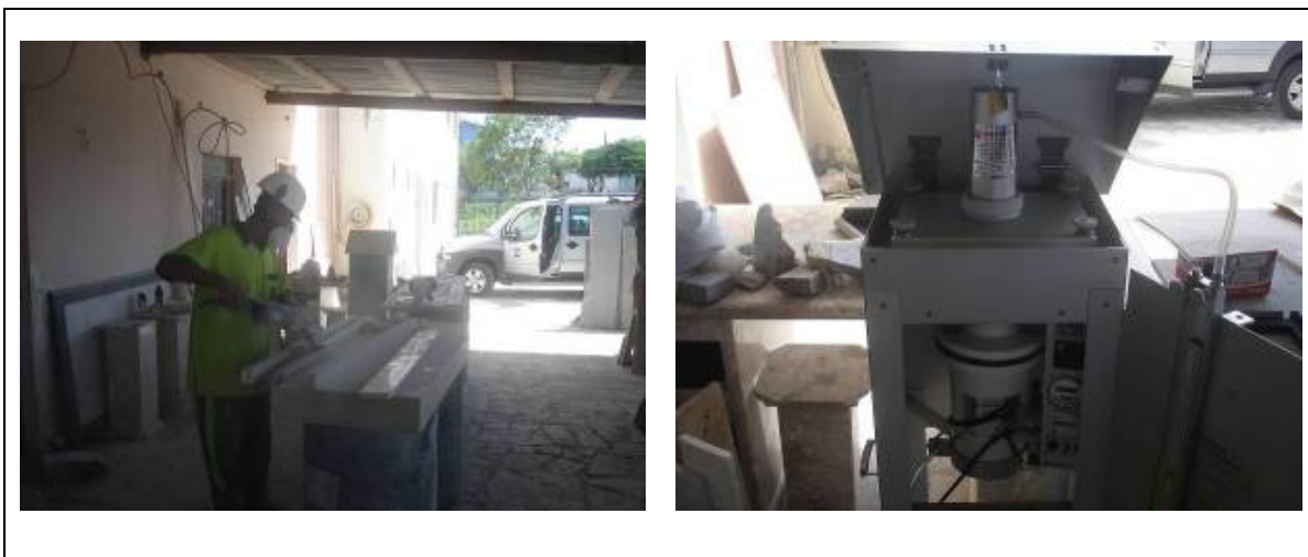
Figura 17: Amostragem de material particulado gerados no processo de beneficiamento do mármore Bege. Foto: Calhau, 2008.
