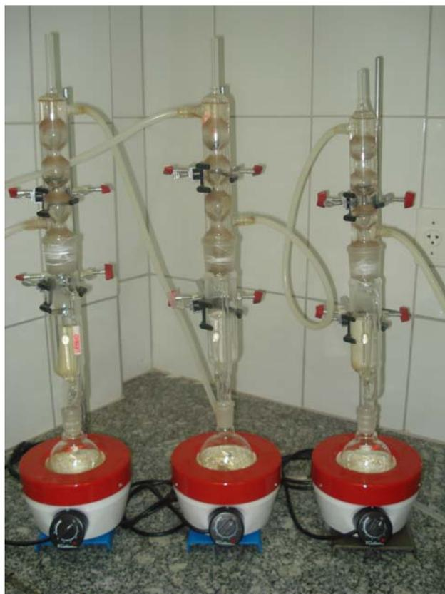
Figura 2 – Extrator do tipo Soxhlet
