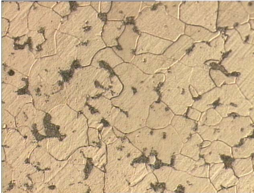
Figura 7-1: Grãos de ferrita e perlita na microestrutura. Mag. 500x.
