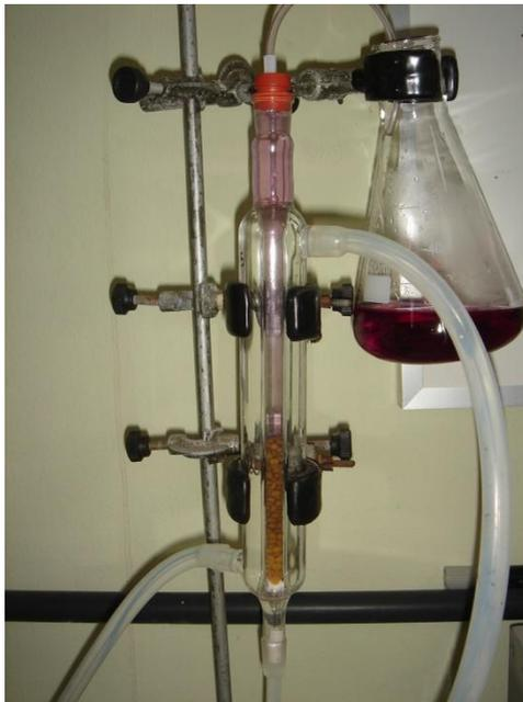
Figura 5.40 – Imagem da cápsula de quitosana em operação no reator contínuo. Detalhe para o escurecimento da cápsula durante o seu uso.
