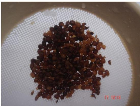
Figura 5.47 – Aspecto do biocatalisador após o contato com o 2,6- DMP, durante um intervalo de tempo igual a 720 minutos.
