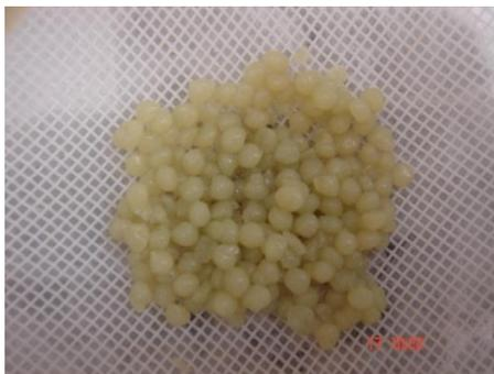
Figura 5.6 – Imagem da cápsula de quitosana imobilizada em pH 6,5, em solução  $6 \text{ g.L}^{-1}$  de enzima lacase. A cápsula foi previamente ativada em solução 1% de glutaraldeído (v/v).
