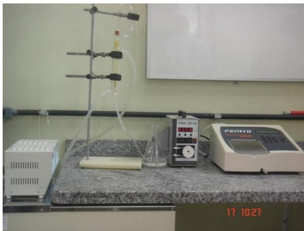
Figura 4.3- Imagem do sistema empregado para estudo da aplicação da lacase imobilizada em reator contínuo de leito fixo.
