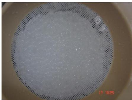
Figura 5.5 – Imagem da cápsula de quitosana obtida após o processo de gotejamento e precipitação em hidróxido de sódio 2 mol.L<sup>-1</sup>.
