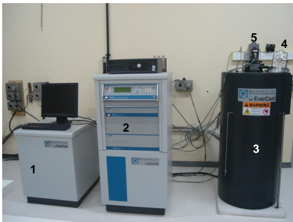
Figura 3.4 – Aparelhagem do sistema de medidas PPMS. Da esquerda para direita, bomba de vácuo, módulo de medidas e Dewar. (1) Bomba de Vácuo, (2) Módulo de controle, (3) Dewar (4) Compressor de He (5) Servo-Motor.
