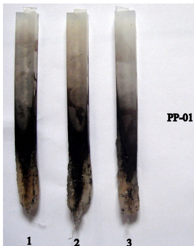
Figura 5.3 - Resultado final do teste de flamabilidade do PP puro.
