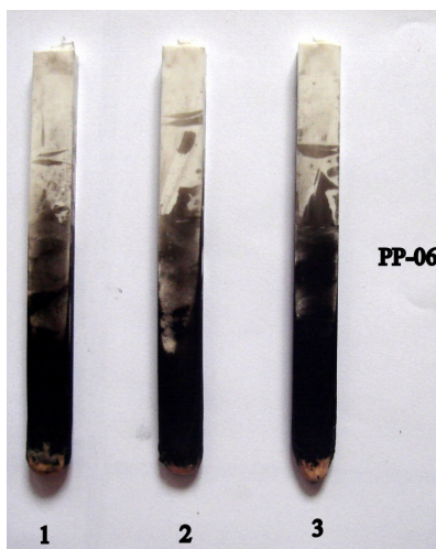
Figura 5. 4 - Ensaio para classificação UL 94 no corpo de prova PP-06
