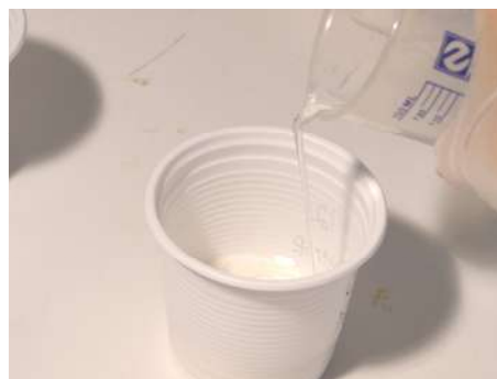
4. Adicione 60 ml de água para 100 gramas de CMF
