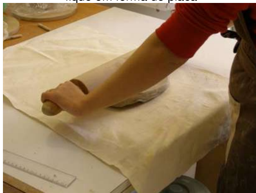
4. Passe rolo sempre do centro da massa para cima e do centro para baixo. A massa irá grudar na lona. Então a retire e vire a parte que estava na lona para cima. Repita este procedimento até que a placa esteja quase na espessura desejada
