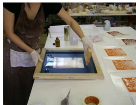
2. Passe o rodo sobre a tela, distribuindo o colóidio pelo espaço vazado
