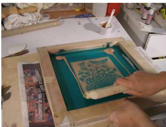
3. Distribua o engobe com o rodo sobre o desenho. Note que a tela deve ser levantada pois neste momento a imagem ainda não é transferida
