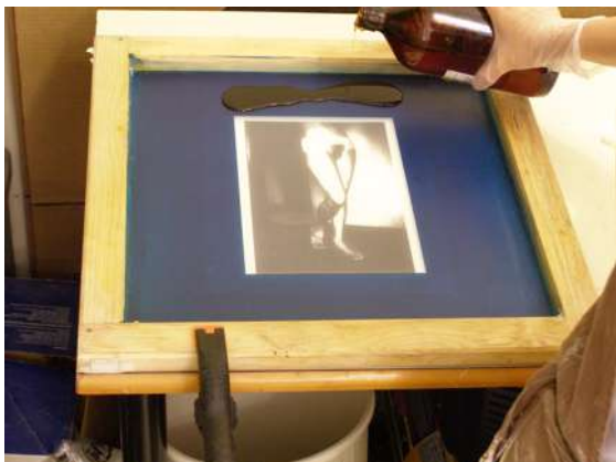
3. Despeje o colódio na parte superior da tela
