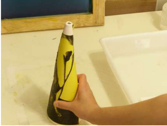
5. Cubra a superfície cerâmica com a película.
