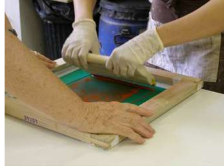
10. Pressione o rodo sobre a tela para transferir a imagem
