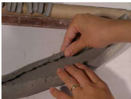
5. Neste exemplo, foi usado um bocal cilíndrico (oco) de 5 cm de diâmetro. Nesta figura, o cilindro está sendo cortado e aberto
