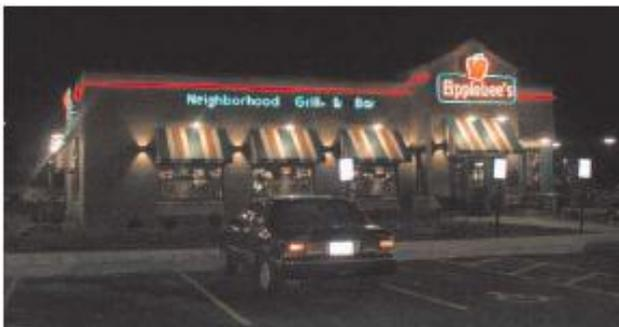
Figura 95: Nesta fachada os LEDs tiveram a mesma performance de uma luz neon quando agrupados lado a lado e internos a um tubo plástico.
