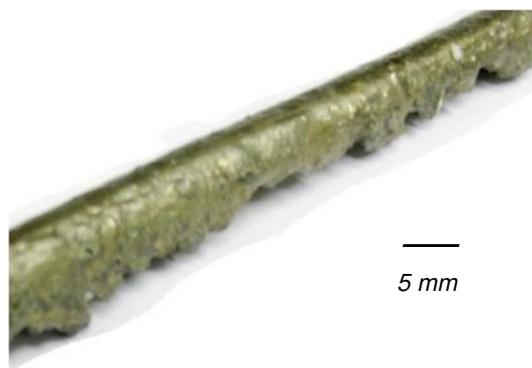
Figura 3. 4 – Visualização da parte “inferior” da vareta de WC-Co , mostrando a superfície ausente de carbonetos.
