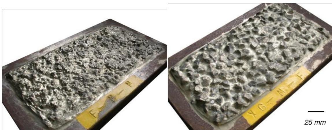
Figura 3.6 – Placa de teste brasado que é estudada a distribuição dos carbonetos após o processo sendo mostrados respectivamente os de carbonetos de granulometria fina e grossa
