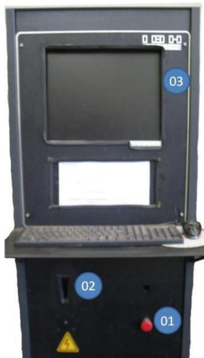
Figura 3. 10 - Central de controle e aquisição: 01 – Botão de parada de emergência; 02 – botão de acionamento da central; 03 – tela de visualização da interface gráfica.
