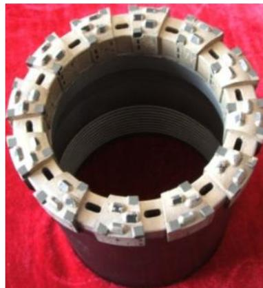
Figura 2. 5 – Cabeça de broca do tipo drag do tipo TSP (China Suppliers, 2010)
