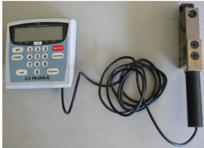
Figura 3. 15 – Célula de carga HBM MB35.
