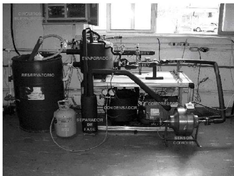
Figura 3.5 - Bancada experimental final com isolamento utilizada para os ensaios.
