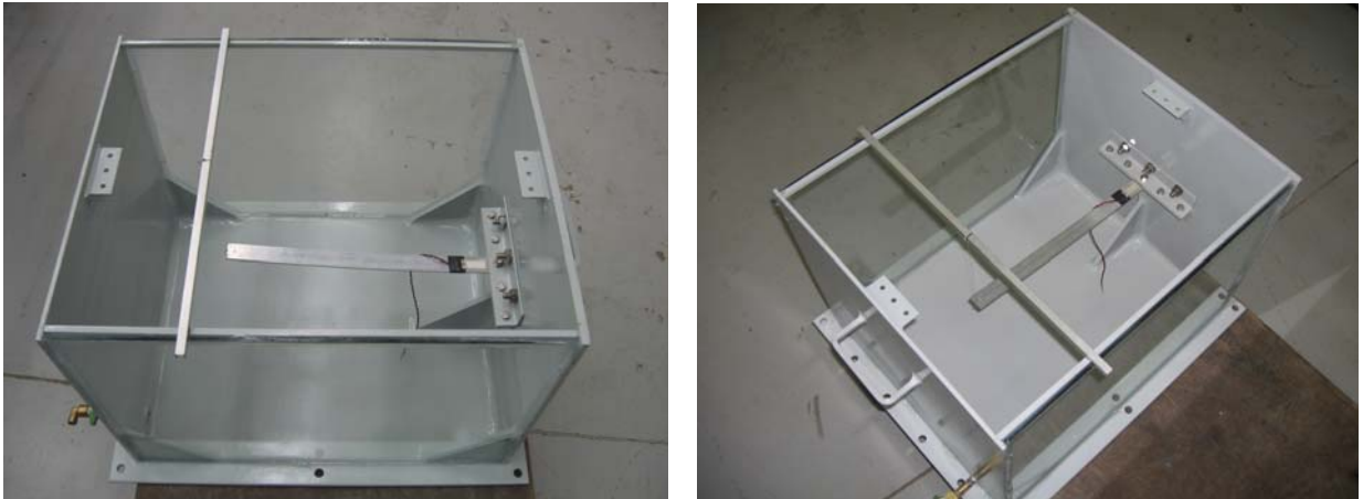
Figura 5.1 – Caixa de aço para experimento com fluido
