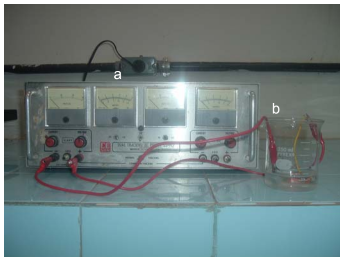
Figura 3.9. Equipamento para ataque eletroquímico: (a) Fonte CG Son Dual Tracking Dc Power Supply; (b) Becker e corpo de prova
