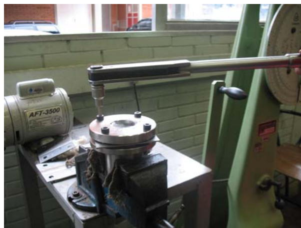
Figura 3.20. Torquímetro utilizado para padronizar a pressão aplicada na chapa pelo prensa chapas do ensaio de embutimento
