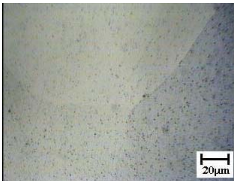
Figura B.15. Microestrutura da zona fundida do corpo de prova de metal de base AISI441 soldado com o metal de adição ER430LNb e o gás de proteção Ar+25%CO 2
