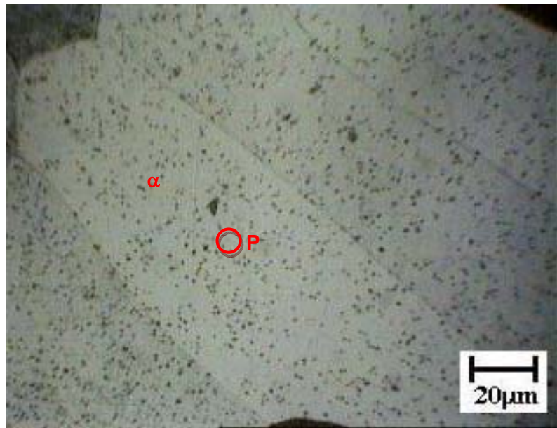
Figura 5.22. Matriz ferrítica ( \alpha ) com precipitados de nióbio (P) da zona fundida do corpo de prova de metal de base UNS43932 soldado com o metal de adição ER430LNb e o gás de proteção Ar+2%O 2
