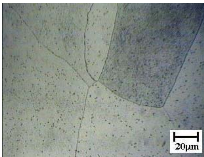
Figura B.7. Microestrutura da zona fundida do corpo de prova de metal de base AISI441 soldado com o metal de adição ER430Ti e o gás de proteção Ar+2%O 2
