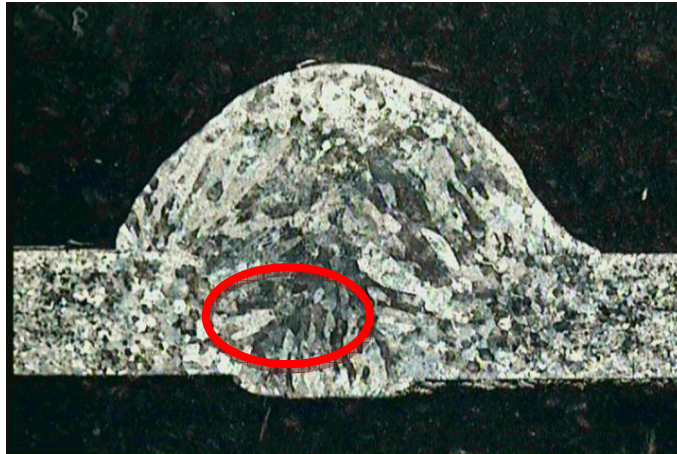
Figura 5.9. Região da zona fundida onde foram realizadas as análises microestruturais para todas as condições de soldagem estudadas
