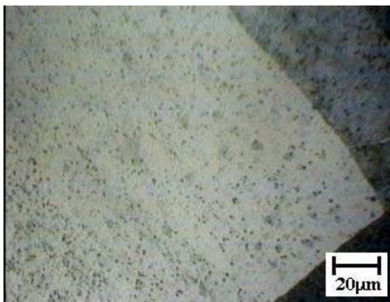
Figura B.11. Microestrutura da zona fundida do corpo de prova de metal de base AISI441 soldado com o metal de adição ER430LNb e o gás de proteção Ar
