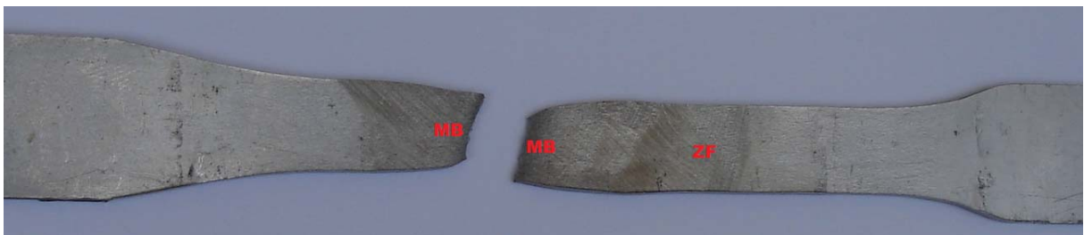
Figura 6.2. Ensaio de tração onde o rompimento ocorreu no MB
