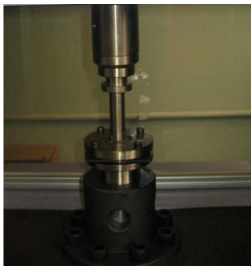
Figura 3.8. Penetrador e matriz prensa chapas utilizados para o ensaio de embutimento na máquina de ensaios estática servo-elétrica
