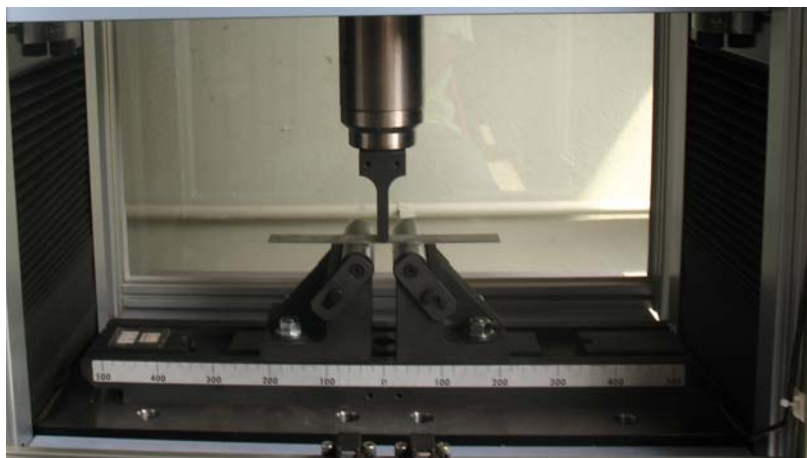
Figura 3.7. Cutelo e guias utilizados no ensaio de dobramento na máquina de ensaios estática servo-elétrica
