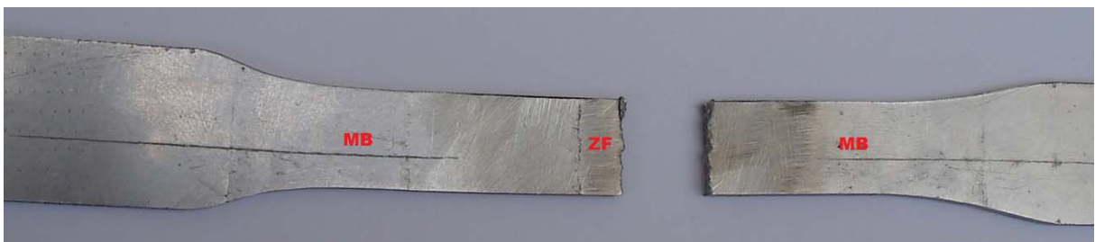
Figura 6.3. Ensaio de tração onde o rompimento ocorreu na junta soldada (zona de ligação)
