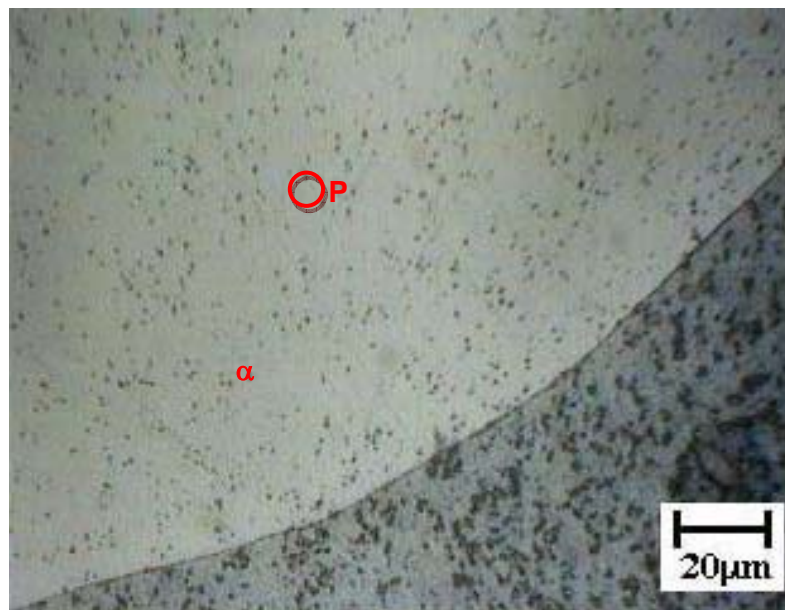
Figura 5.23. Matriz ferrítica ( \alpha ) com precipitados de nióbio (P) da zona fundida do corpo de prova de metal de base UNS43932 soldado com o metal de adição ER430LNb e o gás de proteção Ar+4%CO 2
