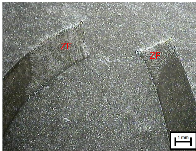
Figura 6.17. Microestrutura do corpo de prova solado com o metal de adição ER430Ti e gás de proteção Ar+25%CO 2 após a realização o ensaio de dobramento na raiz do cordão de solda, enfatizando a região onde ocorreu a fratura com aumento de 10 vezes
