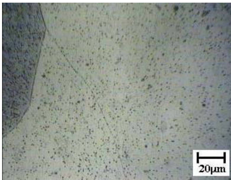
Figura B.12. Microestrutura da zona fundida do corpo de prova de metal de base AISI441 soldado com o metal de adição ER430LNb e o gás de proteção Ar+2%O 2
