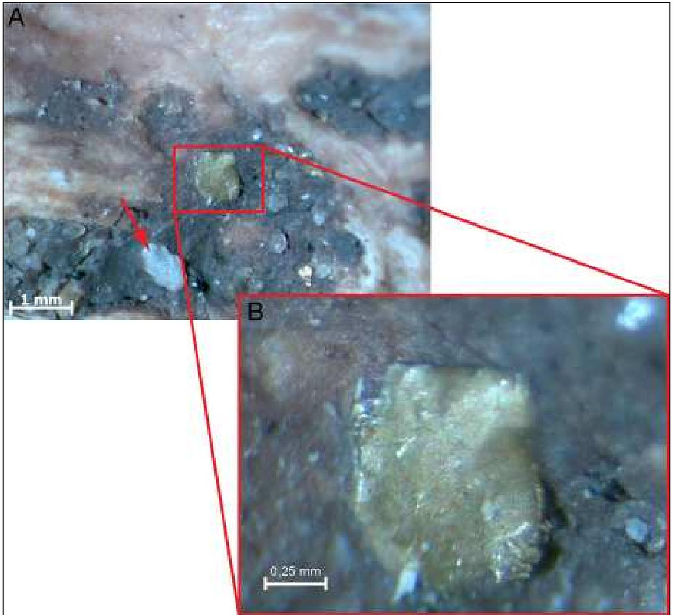
Figura 43 Osso indeterminado com sinais de piritização e incrustação em sua superfície. Na figura (A) a seta indica um seixo de quartzo incrustado na superfície do osso. Em (B) uma aproximação da pirita destacada na figura (A).
