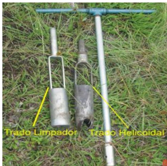
**Figura 4.4.** – Tipos de trados, limpador e helicoidal, utilizados na construção dos furos de sondagem para os ensaios de rebaixamento e de infiltração com o uso do permeômetro de Guelph (imagem extraída de BIELCHOWSKY, 2005).
