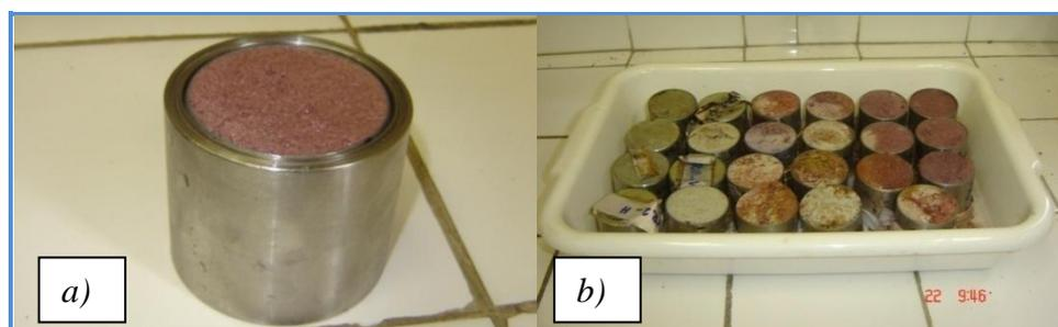
**Figura 4.10.** – Imagens das amostras no cilindro metálico (a) e em saturação durante 48 horas (b).
