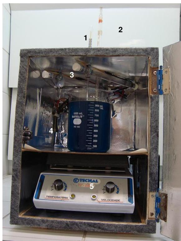
**Figura 07b.** Foto do reator contendo Termômetro (1); Pipeta para coleta (2); Lâmpadas UV (3); Cooler (4) e Agitador magnético (5).
