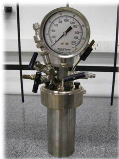
Figura 43. Reator em aço inox, modelo PARR, utilizado nas reações de oligomerização.
