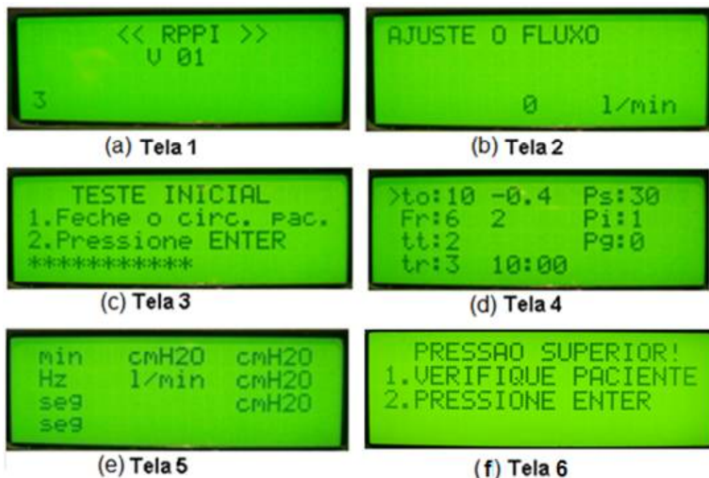
Figura 42 – Telas do SRPPPI: (a) Apresentação e versão do firmware; (b) Ajuste de fluxo; (c) Teste inicial; (d) Parâmetros e navegação; (e) Unidades de medida; (f) Tela de alarme de pressão.
