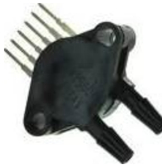
Figura 26 – Sensor de pressão Motorola MPX5500.
