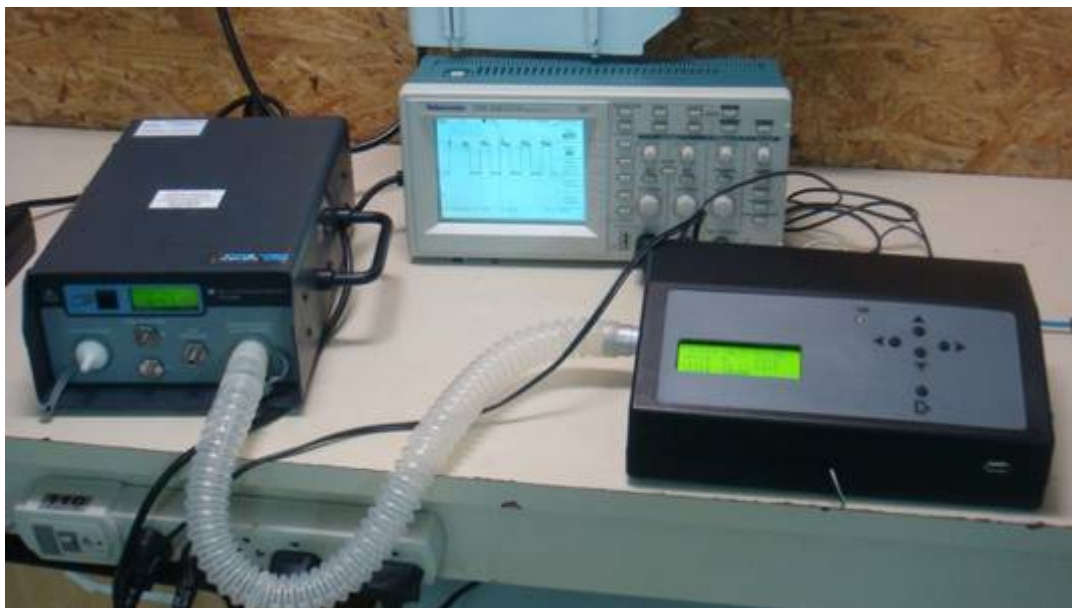
Figura 46 - Medição de fluxo: Arranjo montado para medição do valor real lido pelo PTS-2000 e do valor lido pelo SRPPPI. Ao fundo, o osciloscópio para medição do sinal de resposta do sensor MPX5500 ao acionamento da válvula de fluxo (frequência).
