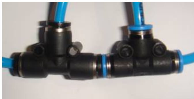
Figura 29 – Arranjo montado para medição de fluxo com o sensor de pressão diferencial MPX5500.
