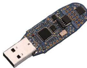
Figura 38 – Dispositivo de programação eZ430 da Texas Instruments.
