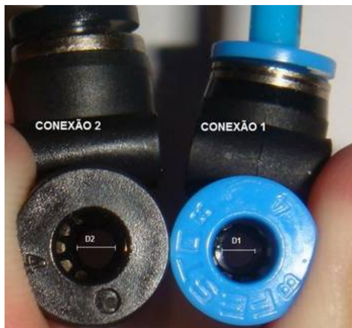
Figura 28 – Conexões de engate rápido 4 mm: Diâmetros internos diferentes.
