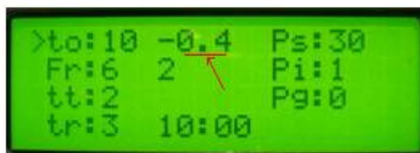
Figura 44 – Tela 4 do SRPPPI: Tela de parâmetros com a medição de pressão mostrada no centro superior da tela.
