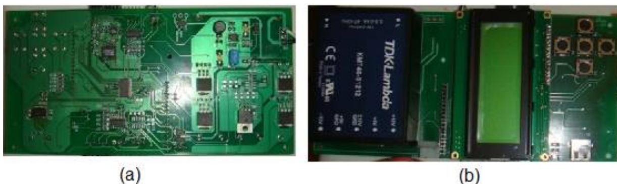
Figura 39 - Placa de circuito impresso utilizado no sistema SRPPPI: (a) faces SMD e (b) PTH.
