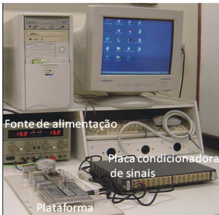
Figura 24 - Conjunto consistindo da célula de carga (plataforma de ensaios), placa condicionadora de sinais e placa de aquisição de dados
