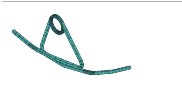
Figura 17 - Desenho esquemático produzido por meio do Método dos Elementos Finito da alça UTFPR Spring desenvolvida pela UTFPR Fonte: Ferreira, Luersen e Borges (2004).
