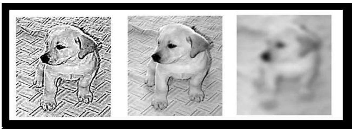
Figura 3. Da esquerda para a direita, a gravura apresenta filtros passa-banda das frequências espaciais altas, médias e baixas. Como podemos observar, as frequências espaciais altas representam os detalhes finos do cachorro, enquanto as frequências espaciais baixas definem o contorno mais grosseiro do animal.
