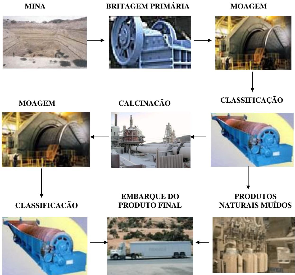
Figura 2.8. Esquema do processo de produção de diatomita em escala industrial (Fonte: SE- Secretaria e Economia, 2006).
