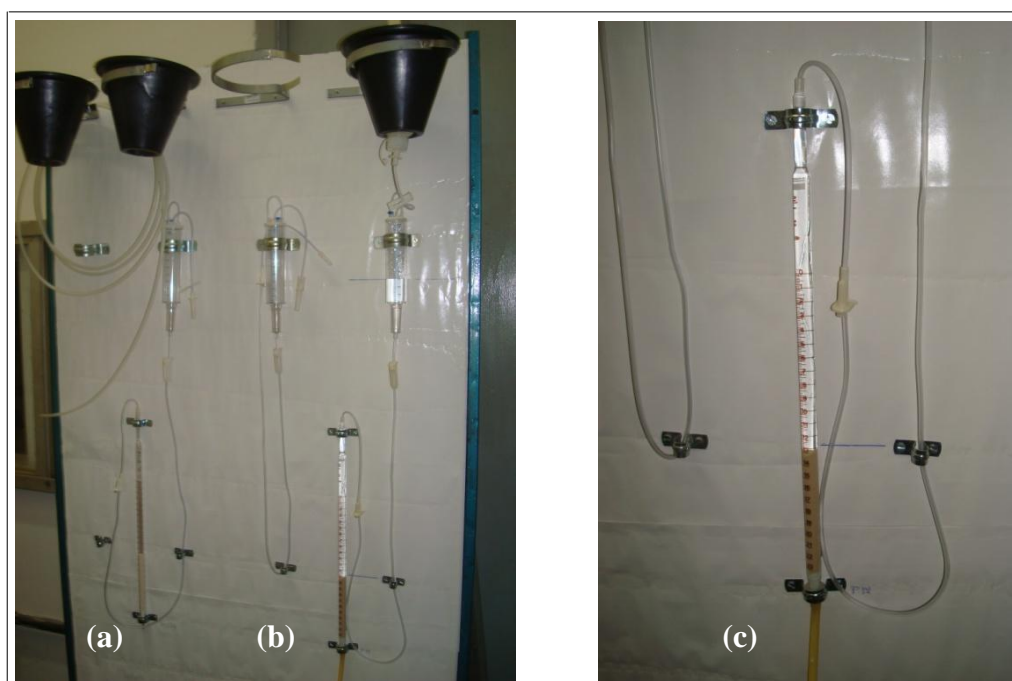
Figura 4.7. Sistema operacional de adsorção em coluna de leito fixo: a) Leito com diatomita calcinada sem fluxante, b) e c) Leito com diatomita calcinada com fluxante.
