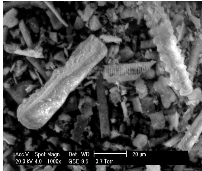
Figura 5.5. Micrografia (MEV) da diatomita calcinada (900 °C, fluxante 4 % Na 2 CO 3 ) nas escalas de 20 µm.
