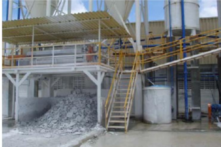
Figura 2-13. Obtenção do resíduo de porcelanato durante a reciclagem da água do processo de polimento (Souza, 2007).
