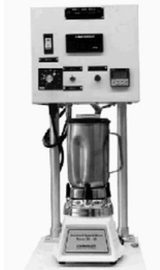
Figura 4-3. Misturador Chandler utilizado na preparação das pastas.
