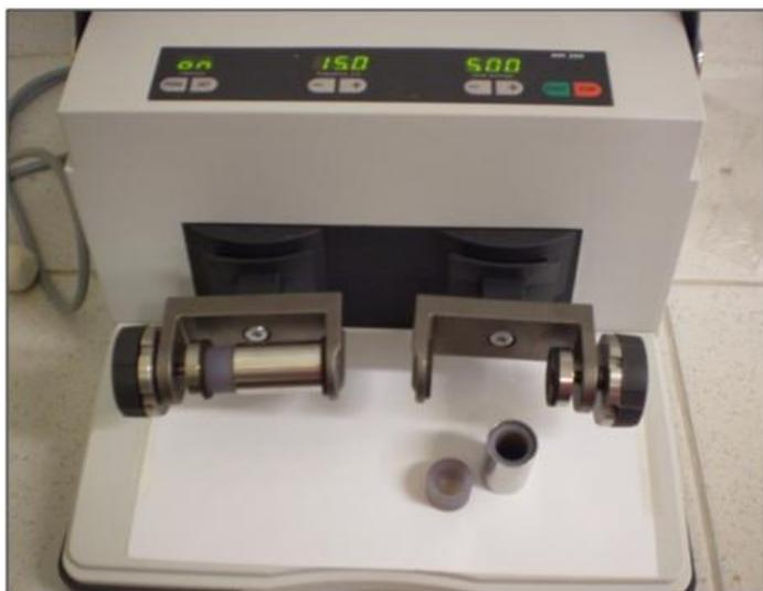
Figura 4.2. Fotografia do moinho de bolas vibratório marca *Retsch* e modelo MM20.
