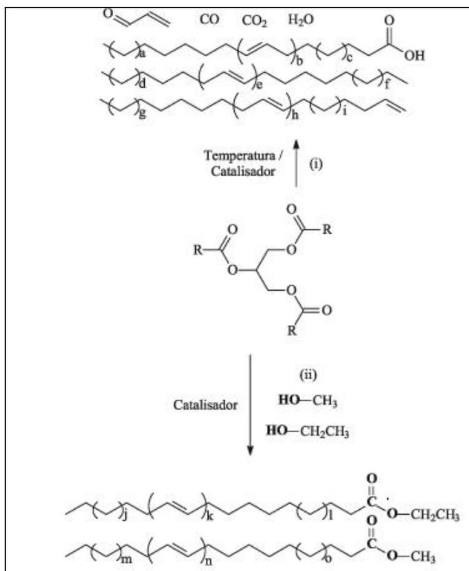
Figura 4: Craqueamento de um triglicerídeo – adaptado de SUAREZ (2007).
