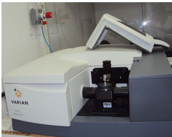
**Figura 14:** Aparelho de Espectrofotômetro no infravermelho médio FTIR da marca VARIAN 660-IR.
