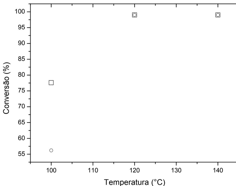
Figura 18: Reação com ácido sulfúrico (H<sub>2</sub>SO<sub>4</sub>) com razão molar álcool:óleo 10:1, e tempo reacional de 90 minutos. (□) 0,1% H<sub>2</sub>SO<sub>4</sub>; (○) 0,5% H<sub>2</sub>SO<sub>4</sub>.
