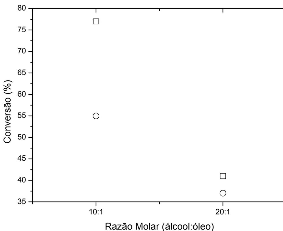
**Figura 19:** Influência da razão molar álcool:óleo sobre o rendimento da reação de transesterificação em reator micro-ondas. T = 100 °C, tempo reacional de 90 minutos. (□) 0,1% H<sub>2</sub>SO<sub>4</sub>; (○) 0,5% H<sub>2</sub>SO<sub>4</sub>.
