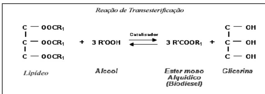
**Figura 6:** reação de transesterificação - PARENTE *et al.*,(2003).
