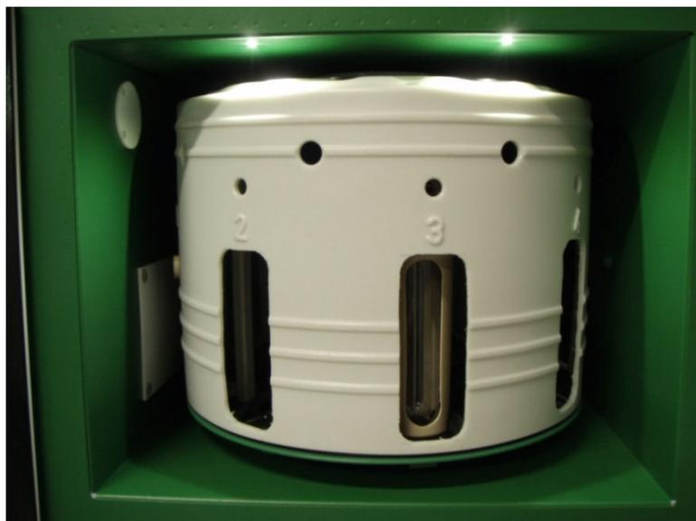
**Figura 15:** Cortes da capa externa e suporte do reator.
