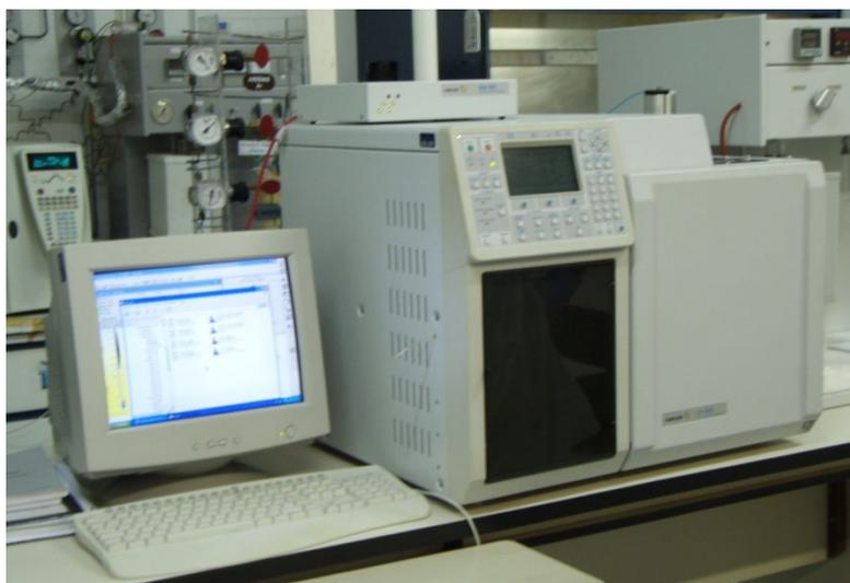
**Figura 12:** Cromatógrafo gasoso - Marca VARIAN modelo CP-3800.
