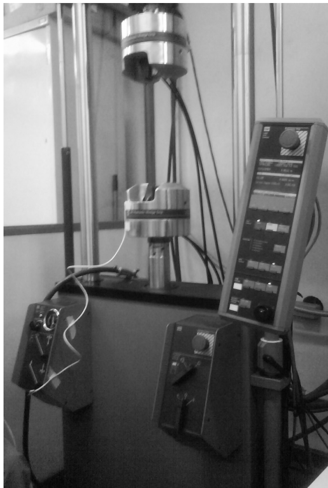
Figura 23 - Mesa vibratória MTS 647 Hydraulic Wedge Grip
