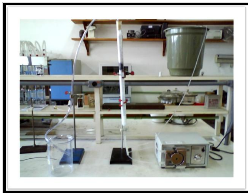
Figura 4-4: Coluna de leito fixo construída com 750/H 2 O/10gv
