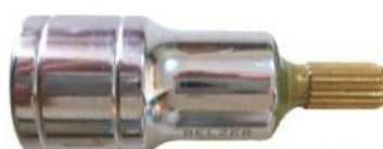
Figura 24 – Sistema de encaixe no transdutor de torque estático para os volantes.
