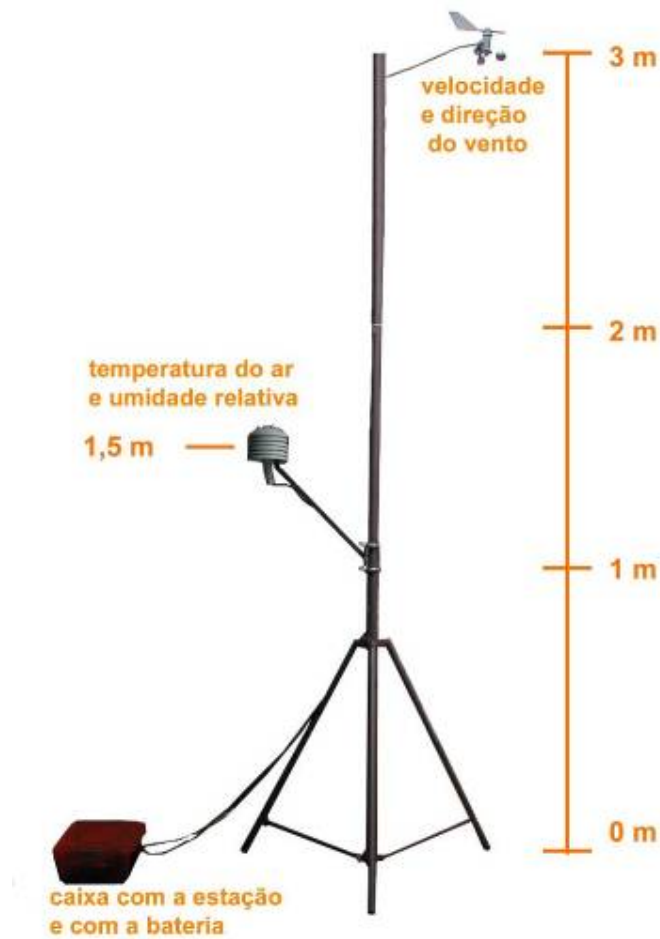
Figura 14: Foto da estação montada em tripé, localização dos equipamentos e cotas das alturas.
