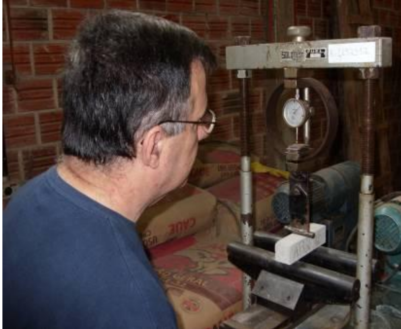
Figura 19 – Ensaio de tração na flexão
