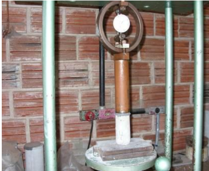
Figura 18 – Ensaio de resistência à compressão
