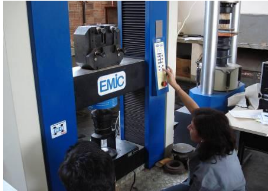
Figura 21 – Preparação do ensaio de módulo de elasticidade estático.
