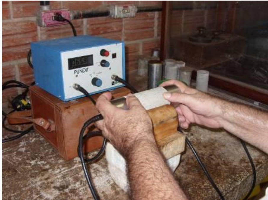
Figura 20 – Ensaio para a determinação do módulo de elasticidade dinâmico.
