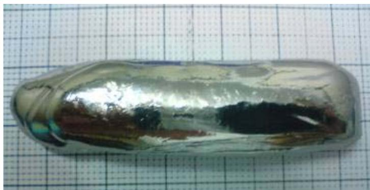
**Figura 11- Lingote da liga Ti-15Mo após a fusão.**
