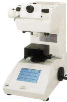
**Figura 26 - Microdurômetro utilizado nas medidas de dureza.**
