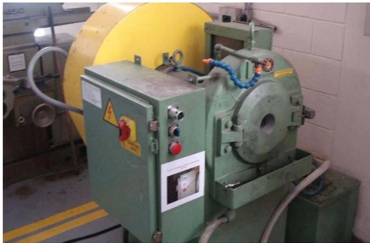
**Figura 12- Equipamento de forjamento rotativo a quente, da marca FENN, modelo EF, com potência de 5 cv e velocidade de 1700 rpm.**
