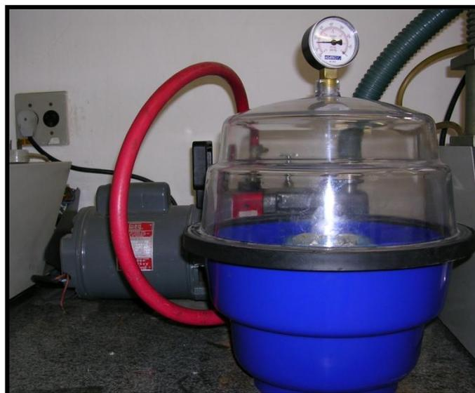
Figura 28 - Câmara de vácuo
