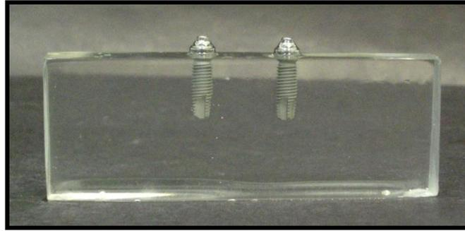
Figura 29 - Modelo fotoelástico obtido
