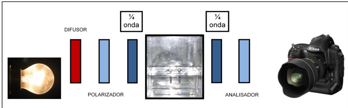
Figura 30 - Esquema polariscópio circular
