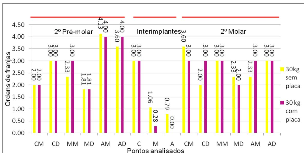
Figura 39 - Ordens de franja decorrentes da aplicação de carga de 30kg nas regiões periimplantares com e sem interposição de placa oclusal plana
