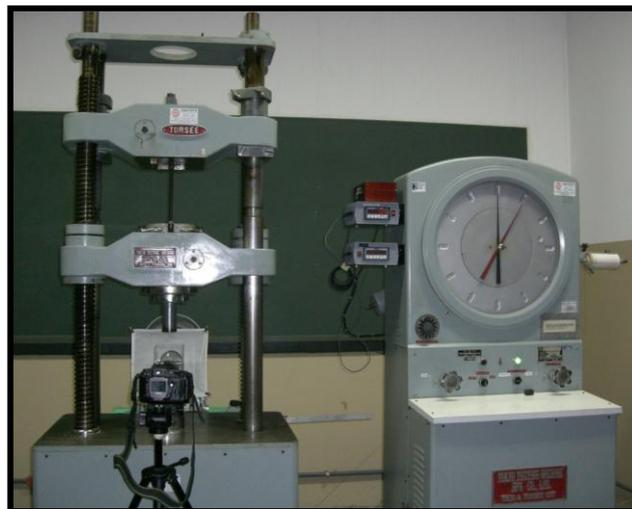
Figura 33 - Máquina utilizada para carregamento e polariscópio circular
