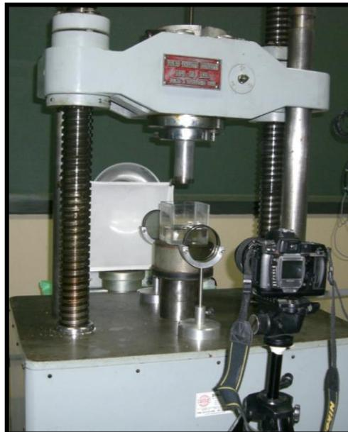
Figura 31 - Polariscópio circular utilizado no experimento
