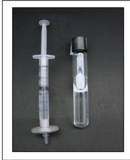
Figura 1 – Preparo das soluções. Todas as soluções foram previamente filtradas (membrana filtrante 0,2 $\mu$ m GV Millex estéril - Millipore-Bedford<sup>®</sup>, MA, USA)
