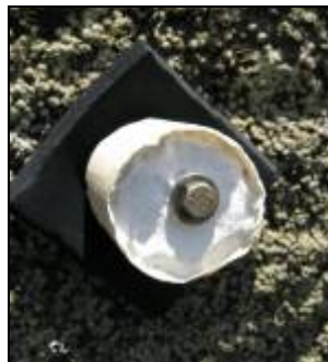
Figura 7 – cilindro de gesso utilizado para estimar o fluxo de água.
