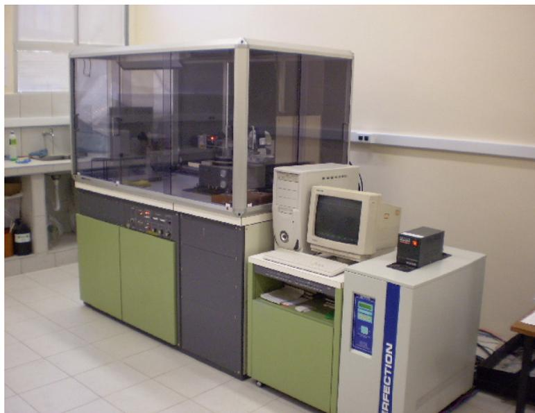
Figura A.7. Difratômetro de raios X em pó Rigaku modelo DMAXB.
