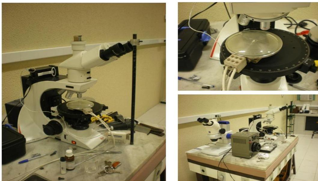
Figura A.4. Microscópio óptico Leica DM2500 P.
