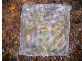
Figura 2 – Bolsa de decomposição de aço inoxidável com 2mm de malha.
