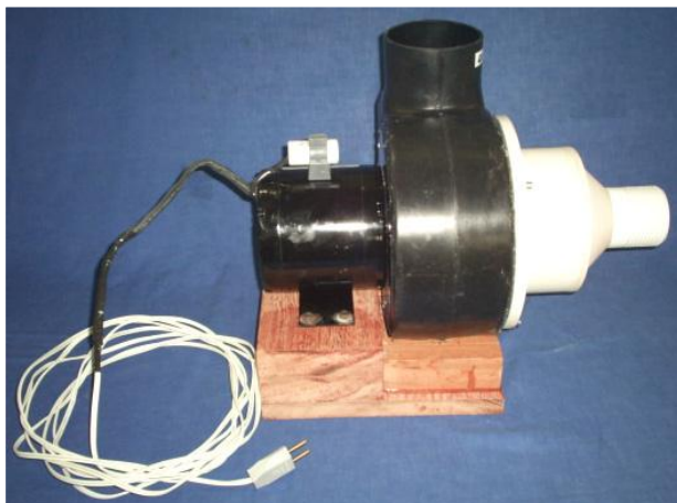
Figura III.10 – Foto do exaustor com o redutor para mangueira de PVC.
