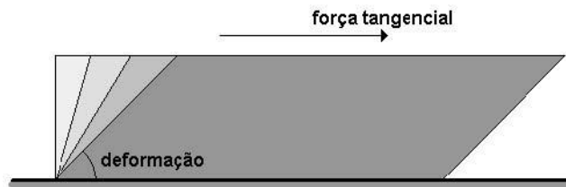
Figura D1 – Escoamento de um fluido sob a ação de uma força tangencial.
