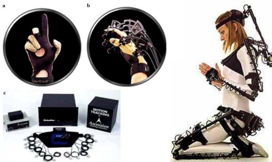
Figura 1-3: captura de movimentos usando hardware especializado [13].
