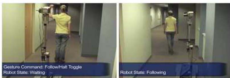
Figura 1-2: robô controlado pelo humano através de gestos da mão [12].
