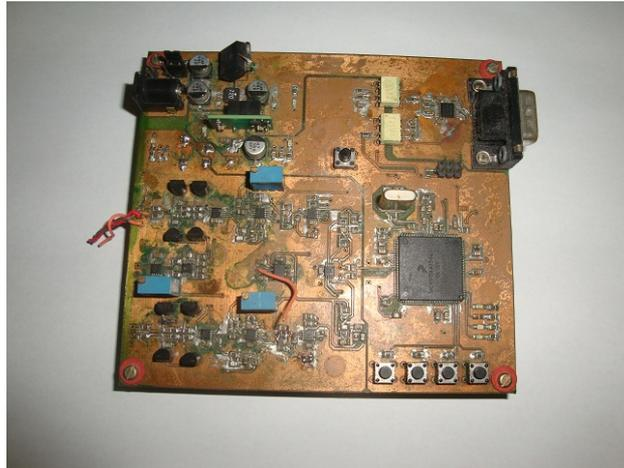
Figura 4.28: primeiro protótipo desenvolvido, possui interface RS232, processador HCS12 e dois canais de amplificação.
