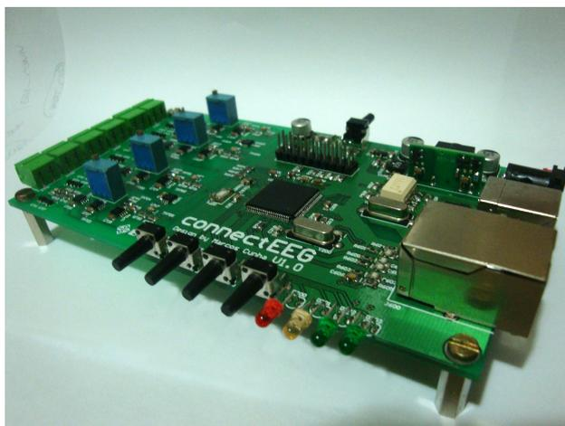
Figura 4.30: terceiro protótipo, apresenta quatro canais de amplificação, processador LM3S6965, interface de comunicação *ethernet* e USB.
