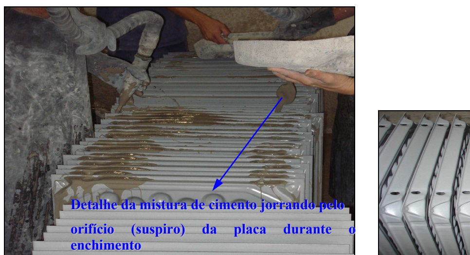
Figura 3.20. Etapa de enchimento das placas do piso elevado (detalhe dos dois furos por placa na imagem menor)
