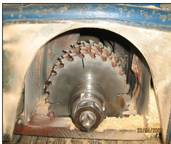
Figura 4.2. Detalhe do conjunto de cinco serras na multilâmina
