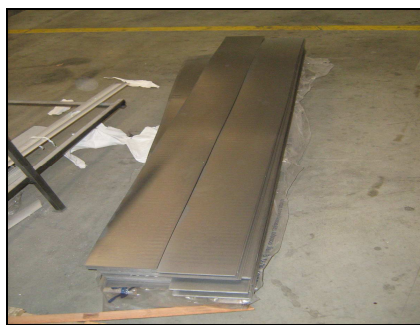
Figura 3.17. Tiras de chapa de aço cortadas, empilhadas, para a produção das chapas quadradas a serem estampadas, utilizadas na fabricação de cruzetas ou bases da cruzeta
