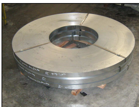
Figura 3.18. Três bobinas de chapa de aço empilhadas uma sobre a outra
