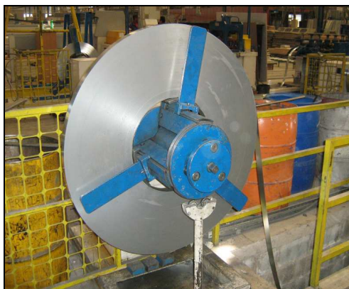
Figura 4.6. Detalhe de um desbobinador motorizado de chapa de aço (imagem do lado oposto ao motor)
