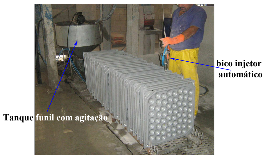
Figura 4.7. Equipamento dosador de cimento em funcionamento
