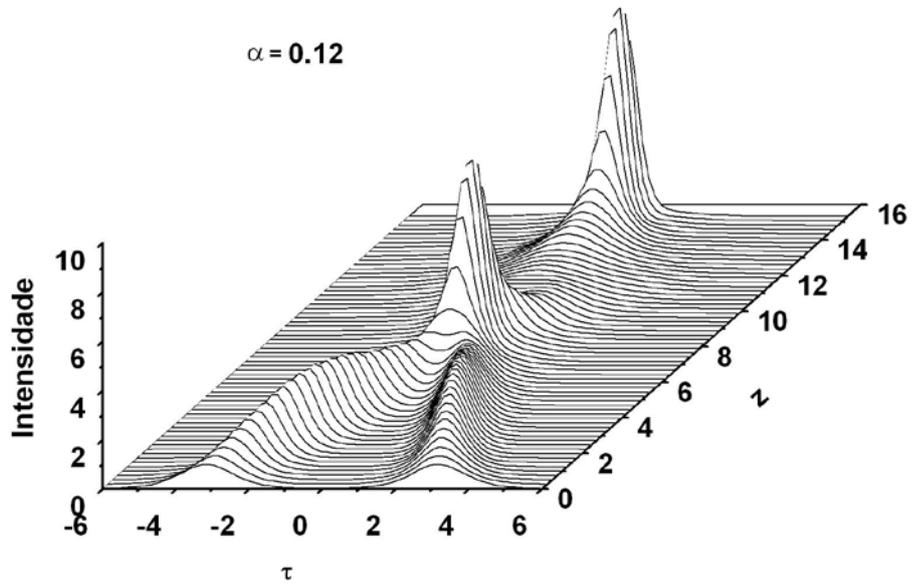
Figura 3.13. Colisão de sólitos ópticos espaço-temporais com  $\alpha = 0.12$  em função da distância de propagação  $z$ .
