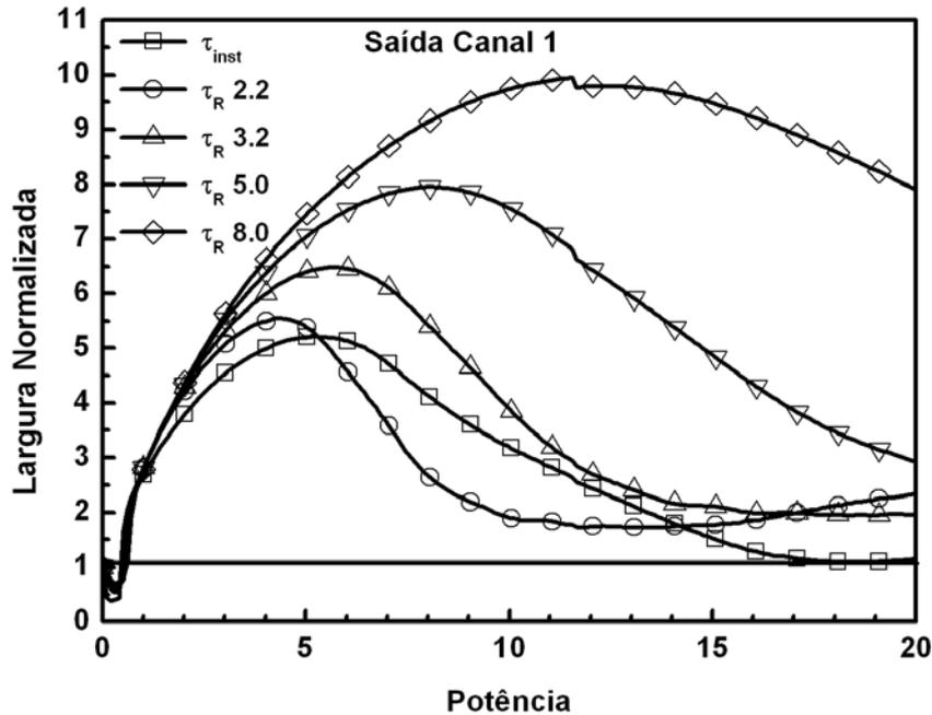
Figura 5.6 - Largura Normalizada (LN1) na saída do canal 1 para acoplador direcional duplo simétrico de fibras ópticas, instantâneo e relaxado com  $\tau_R = (2, 2; 3, 2; 5, 0; 8, 0)$  ps variando a potência.
