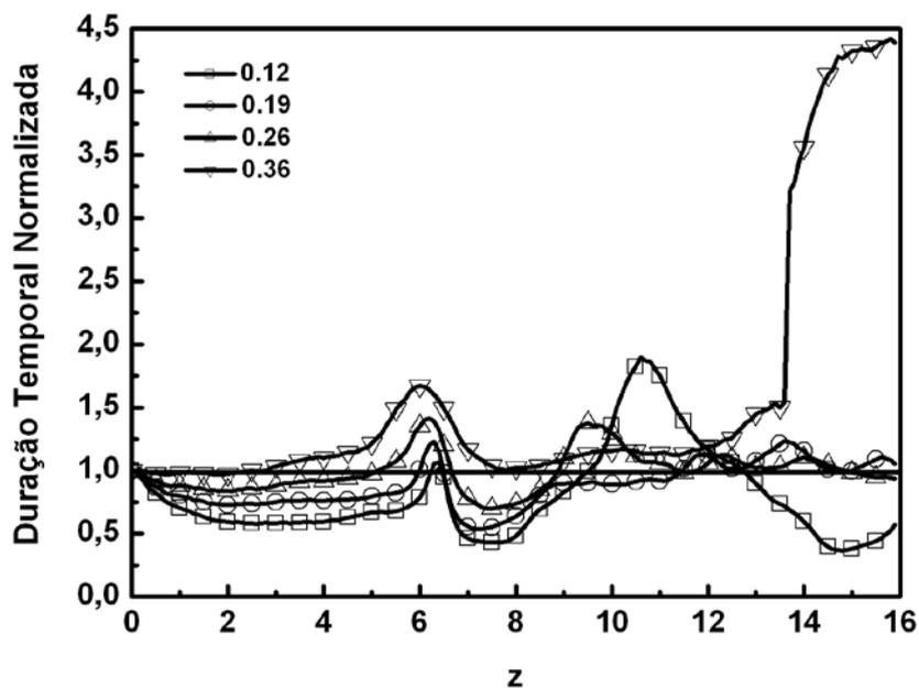
Figura 3.11. Duração temporal normalizada ( $\tau=T/T_0$ ) do campo óptico em função da distância de propagação  $z$  para  $\alpha = (0,12; 0,19; 0,26; 0,36)$  no caso de colisão.
