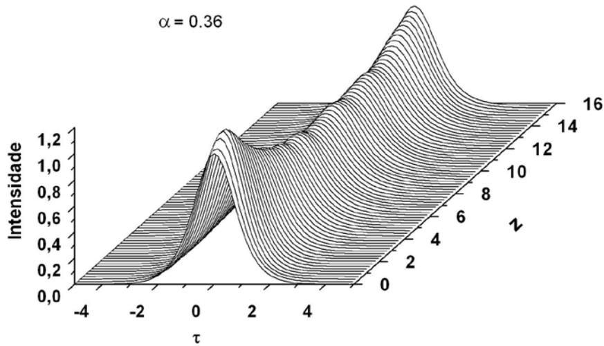
Figura 3.9. Evolução do pulso óptico com  $\alpha = 0.36$  observando o perfil temporal.
