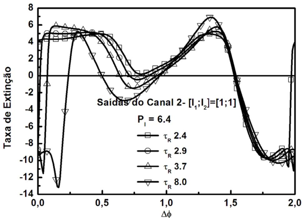
Figura 7.7 - Taxa de extinção 2 ( $XR2$ ) em função do defasamento  $\Delta\phi$ , para a Potência de entrada
