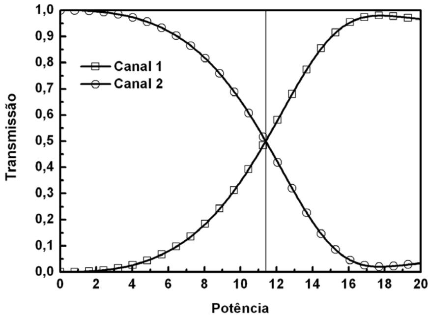
Figura 5.1 - Curva de transmissão instantânea para um acoplador direcional duplo simétrico de fibras ópticas, de comprimento  $L_C$ . Nesta condição  $P_C=11,4$  W.
