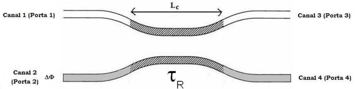
Figura 7.1 - Modelo de acoplador direcional duplo assimétrico de fibras ópticas, de comprimento  $Lc$ , proposto para obtenção das portas lógicas.
