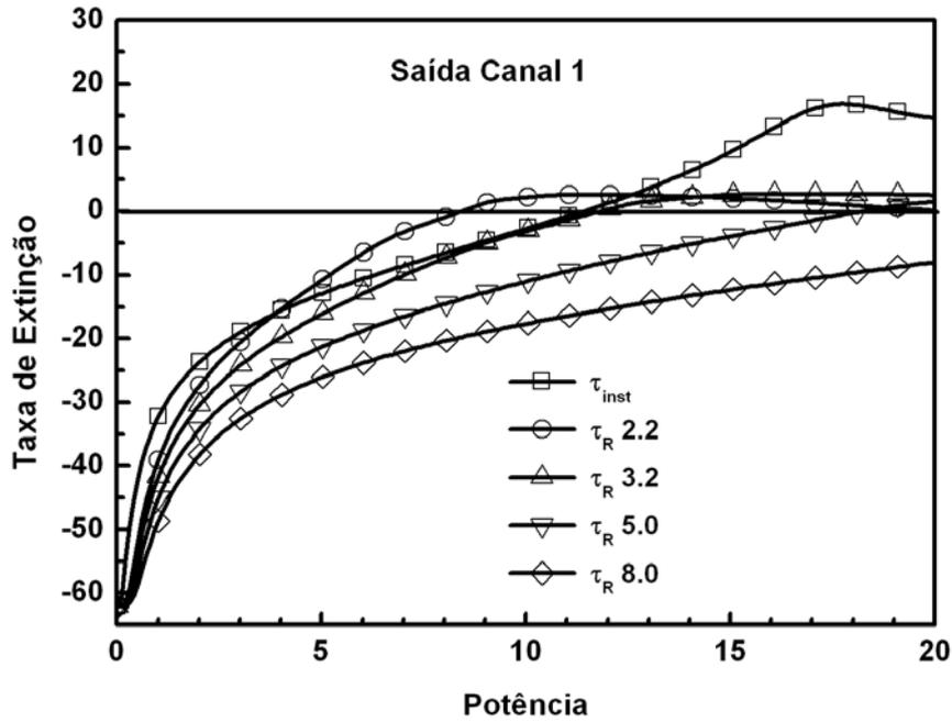
Figura 5.7 - Taxa de extinção 1 (XR1) para acoplador direcional duplo simétrico de fibras ópticas instantâneo e relaxado com  $\tau_R = (2, 2; 3, 2; 5, 0; 8, 0)$  ps variando a potência.
