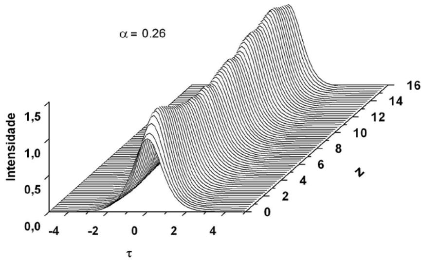
Figura 3.7. Evolução do pulso óptico com  $\alpha = 0.26$  observando o perfil temporal.
