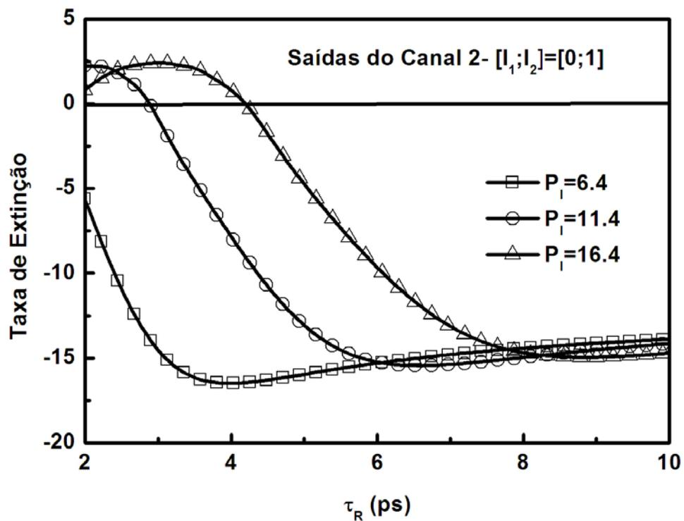
Figura 7.3 - Taxa de extinção 2 (XR2) em função do Tempo de Relaxação  $\tau_R$ , para as Potências de entrada  $P_i=6,4;11,4;16,4$ , com as entradas  $[(I_1; I_2)]=[0;1]$ .
