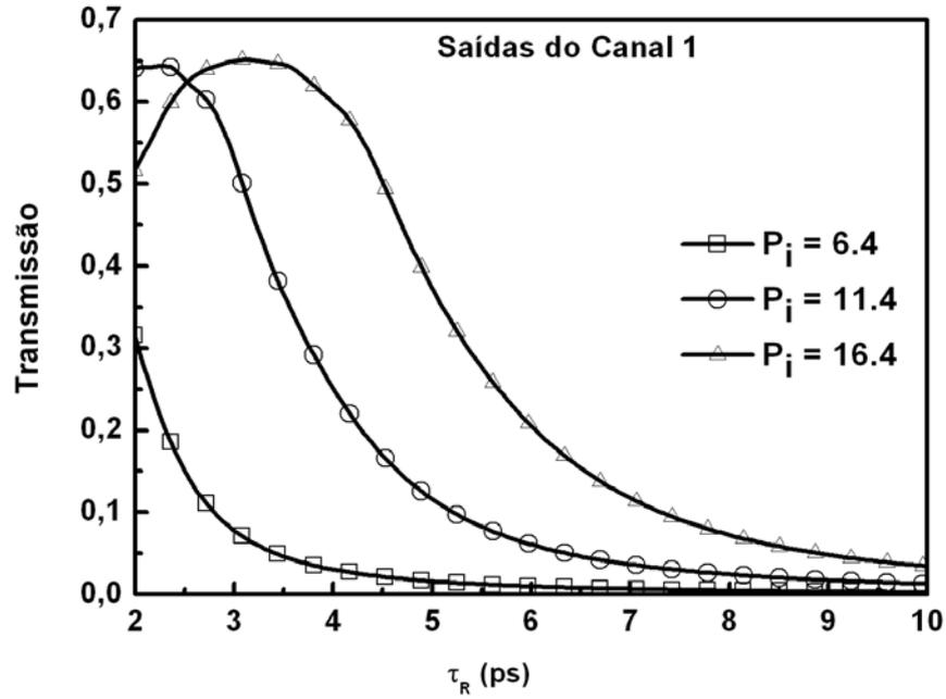
Figura 5.2 - Curva de transmissão na saída do canal 1 do acoplador direcional duplo simétrico relaxado, de comprimento  $L_C$ , em função do tempo de relaxação  $\tau_R$  operando com pulsos na forma de sóliton fundamental com 2ps de largura.
