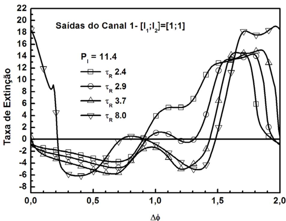
Figura 7.8 - Taxa de extinção 1 (XR1) em função do defasamento  $\Delta\phi$ , para a Potência de entrada  $P_I = 11,4$ , com as entradas  $[I_1; I_2] = [1; 1]$  e  $\tau_R = (2,4; 2,9; 3,7; 8,0)$ .
