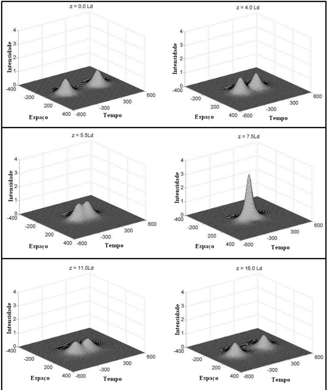
Figura 3.12. Colisão de sólitos ópticos espaço-temporais com  $\alpha = 0.26$  considerando seis distâncias de propagação  $z = (0; 4L_d; 5.5L_d; 7.5L_d; 11L_d; 16L_d)$ .
