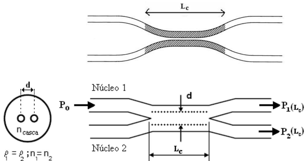
Figura 4.2 - Acoplador Simétrico.
