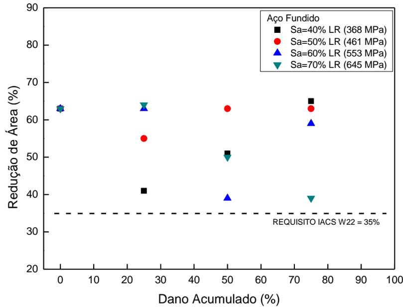
Figura III.7: Variação da Redução de Área com a vida consumida para o aço fundido
