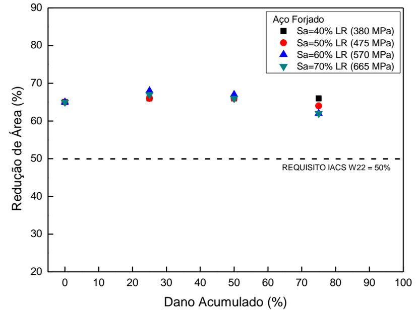
Figura III.8: Variação da Redução de Área com a vida consumida para o aço forjado
