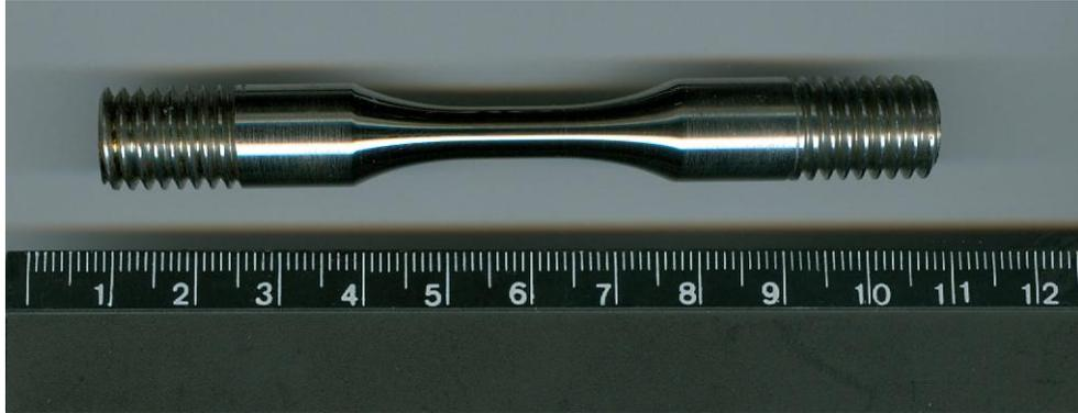
Figura II.2: Corpo-de-prova utilizado nos ensaios de fadiga
