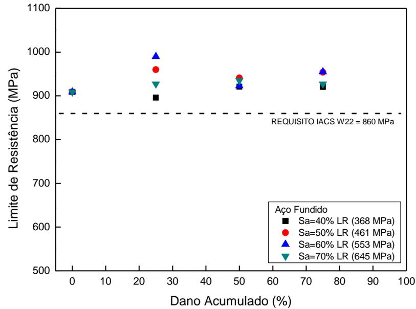
Figura III.5: Variação do Limite de Resistência com a vida consumida para o aço fundido
