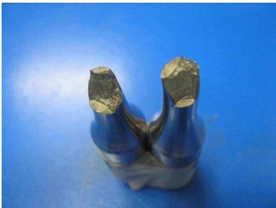
Figura IV.6: Corpo-de-prova de manilha (fundido) após ensaio de tração com dano acumulado em fadiga de 75%
