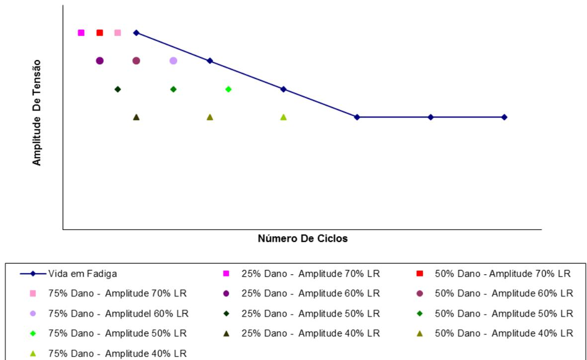
Figura II.3: Plano para ensaios de levantamento de curvas S-N e de ciclos de vida em fadiga de alto ciclo
