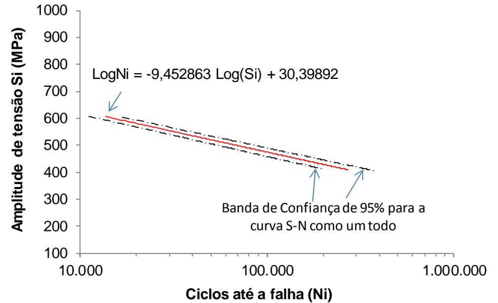
Figura IV.3: Banda de Confiança para a curva S-N levantada para corpos-de-prova de placa triangular (aço forjado).
