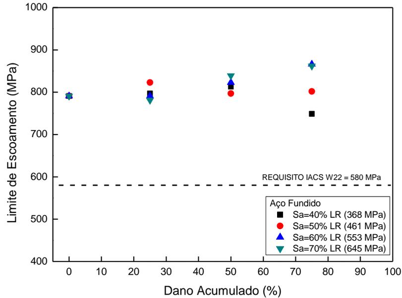
Figura III.3: Variação do Limite de Escoamento com a vida consumida para o aço fundido.
