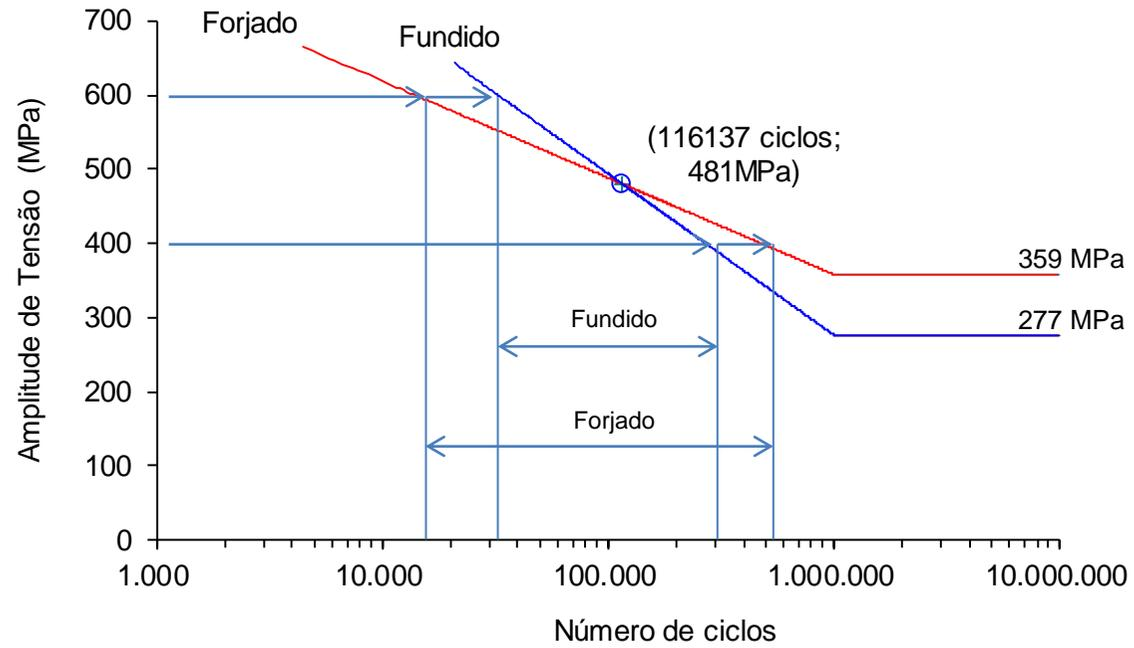
Figura IV.1: Comparação entre as curvas S-N levantadas para aços IACS W22 Grau R4 fundido e forjado
