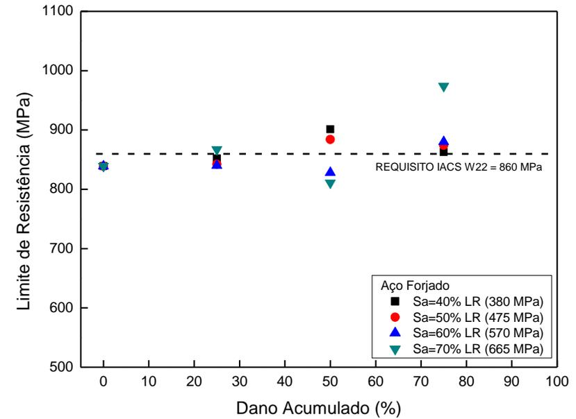
Figura III.6: Variação do Limite de Resistência com a vida consumida para o aço forjado.
