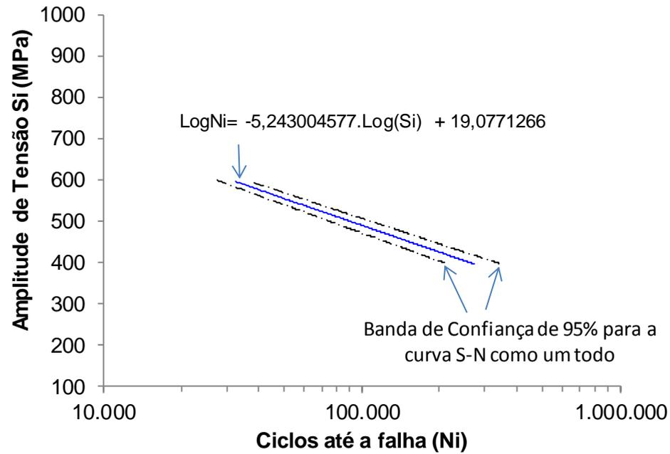
Figura IV.2: Banda de Confiança de 95% para a curva S-N levantada para corpos-de-prova de manilha (aço fundido).
