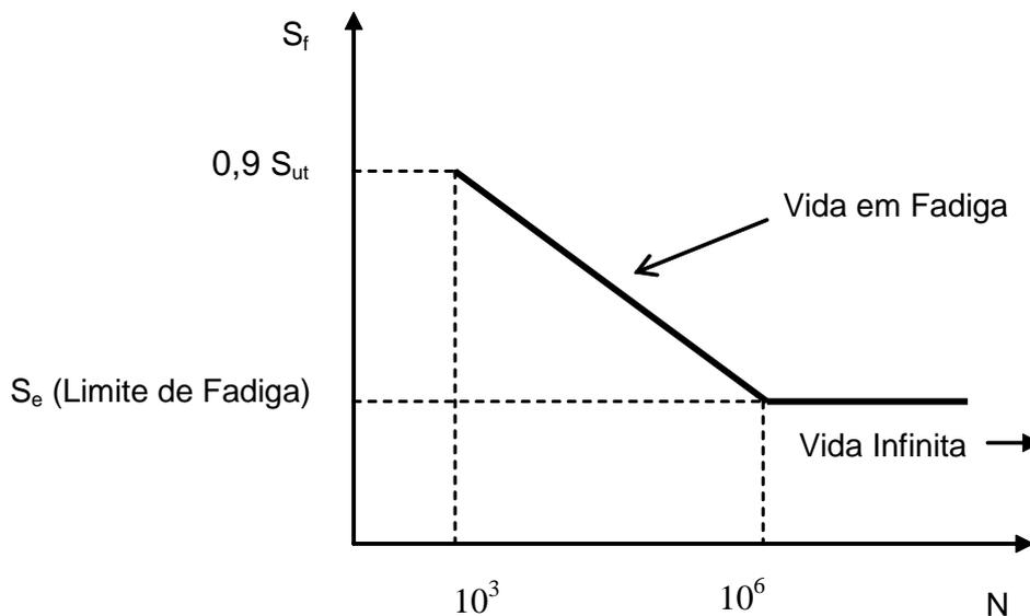
Figura I.1: Curva S-N típica para aços
