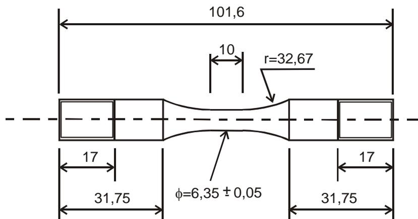
Figura II.1: Dimensões de corpo-de-prova conforme recomendado pelo Manual de Ensaio de Fadiga STP 566 (ASTM, 1974) com modificações – Cotas em mm convertidas de polegadas.
