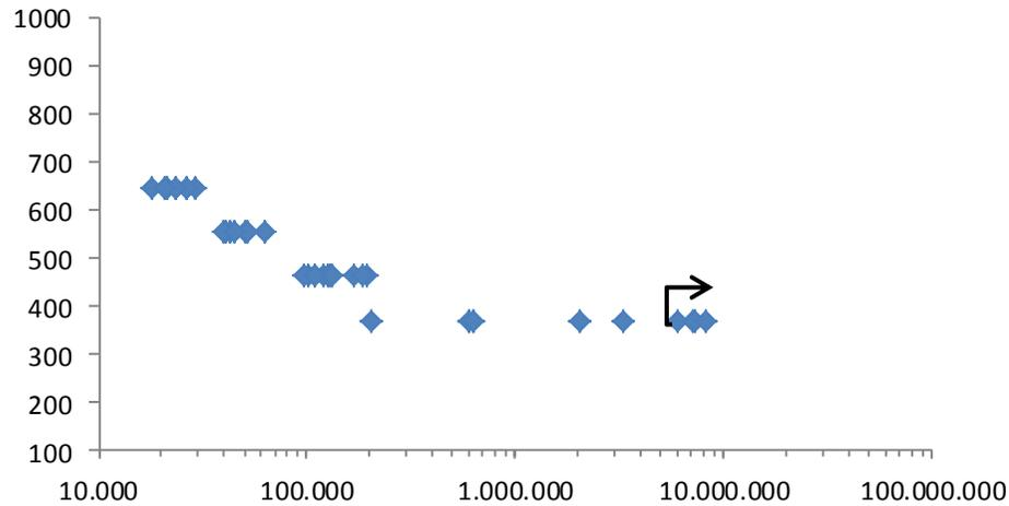
Figura IV.4: Gráfico de dispersão dos resultados para o aço fundido.
