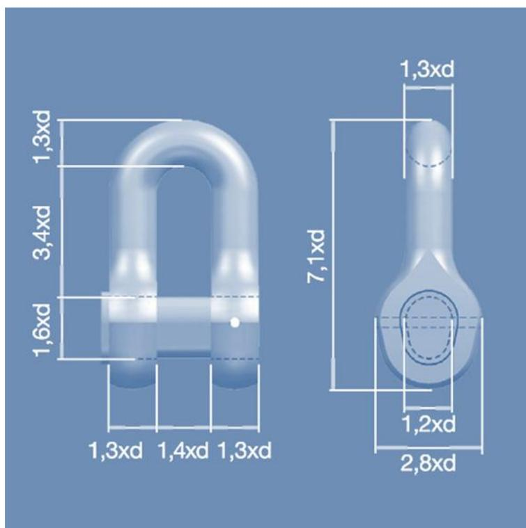
Figura I.6: Manilha típica disponível em [http://www.vicinaycadenas.net/eng/marine\\_chains/shackles.html](http://www.vicinaycadenas.net/eng/marine_chains/shackles.html), acesso em 31/07/2010.
