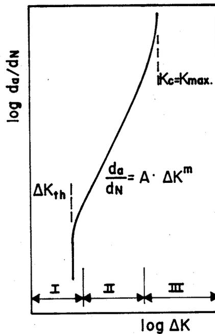
Figura I.5: Estágios de propagação da trinca – Método  $da/dN/\Delta K$  (KENEDI, 1991).
