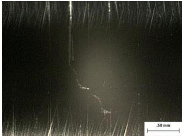
Figura IV.7: Trinca na superfície de um corpo-de-prova de aço fundido com dano de 75% observado em lupa estereoscópica.
