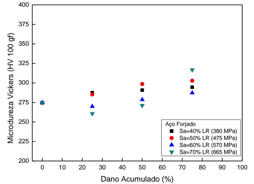
Figura III.10: Variação da Microdureza com o dano acumulado para corpos-de-prova de aço forjado
