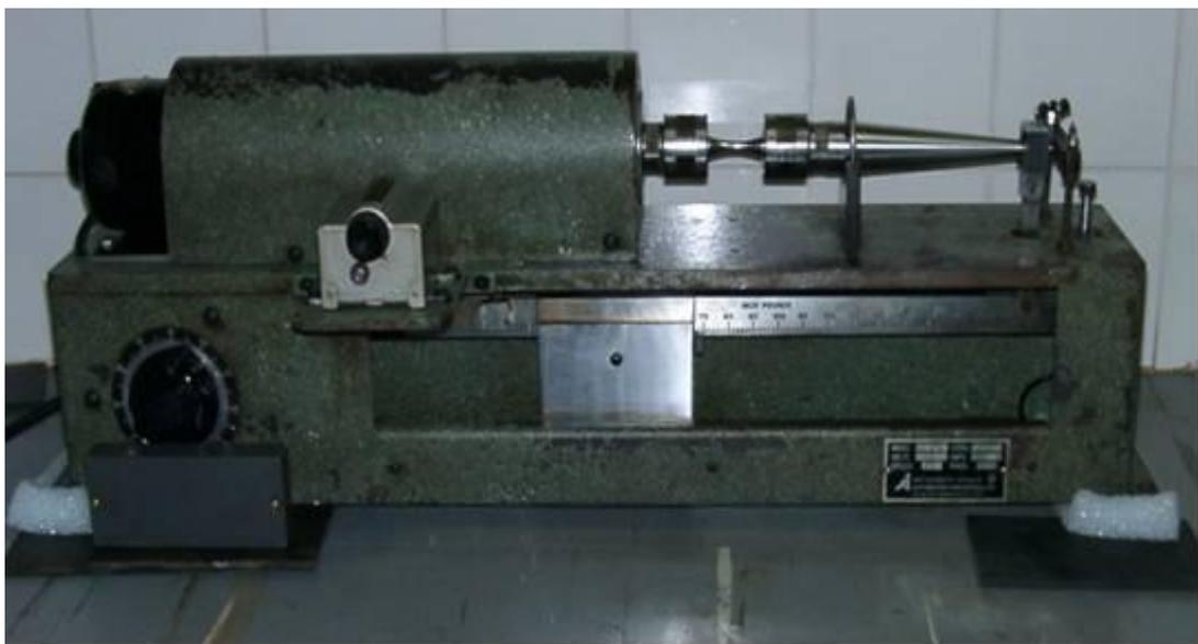
Figura II.4: Máquina utilizada nos ensaios de fadiga – Laboratório de Materiais CEFET-RJ.
