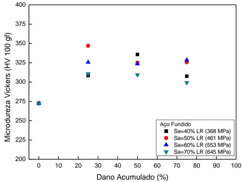
Figura III.9: Variação da Microdureza com o dano acumulado para corpos-de-prova de aço fundido
