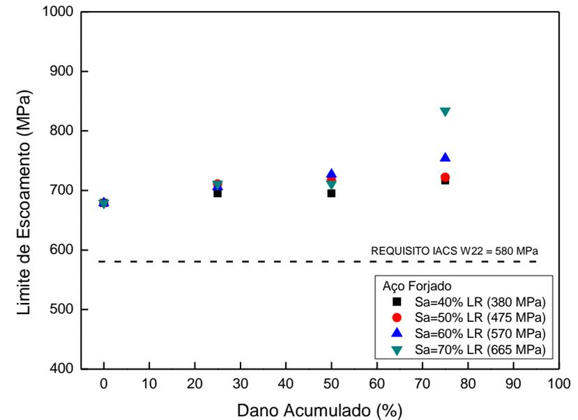
Figura III.4: Variação do Limite de Escoamento com a vida consumida para o aço forjado.
