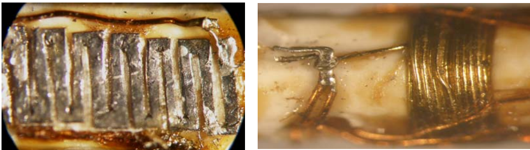
Figura 3.7. Fotografias do chumbo e bobina de manganina que foram usadas como monômetros de pressão.
